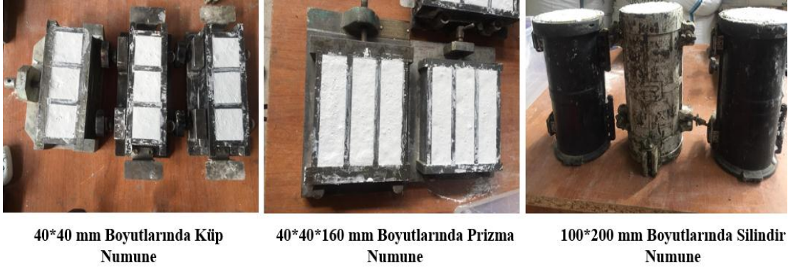
Şekil 6.2. DH-02 adlı sıva malzemesiyle hazırlanan numuneler
