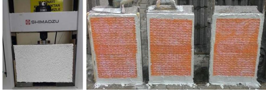
Şekil 1.7. Deney düzeneği (a) ve sismik tekstil malzemesi kullanılarak güçlendirilen üçlü test numuneleri [13]
