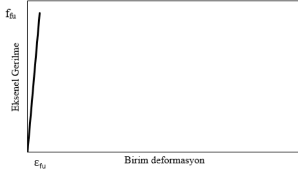
Şekil 3.3. FRP malzemesinin gerilme-birim deformasyon ilişkisi
