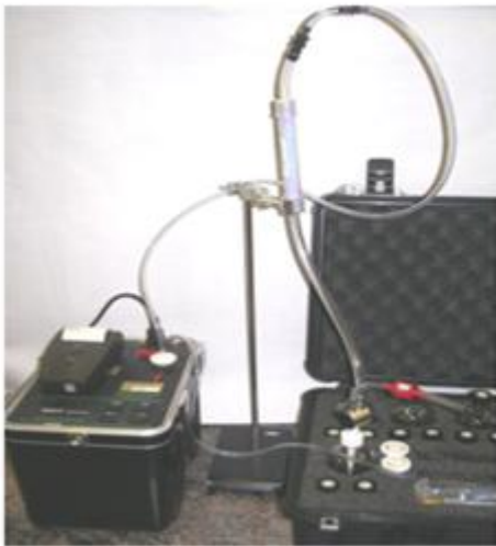
Şekil 3.2. Köpüren su örneğinin RAD7 detektörüne bağlanması
