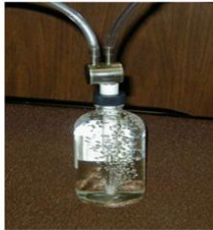
Şekil 3.2. Köpüren su örneğinin RAD7 detektörüne bağlanması
