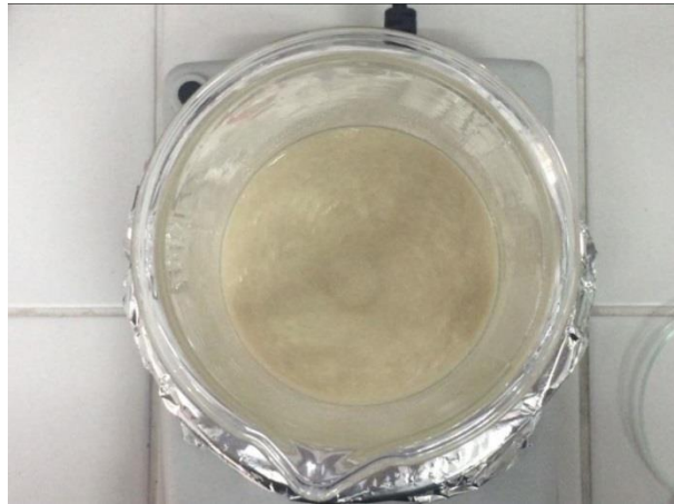
Şekil 3.4. Asetik asit çözeltisi ile kitosanın manyetik karıştırıcıda karıştırılması
