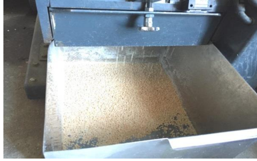
Şekil 3.3. Granül haline getirilmiş PP kompozitleri
