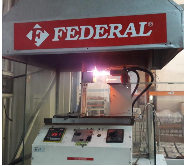
Şekil 3.15. Federal KT01 kızaran tel test cihazı
