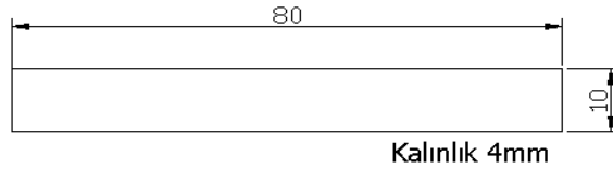
Şekil 3.12. Eğilme deneyi numunelerinin şekli ve boyutları [88]
