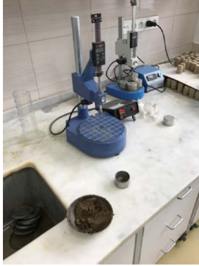
Şekil 4.6. Konik penetrometre deneyi yapılışı
