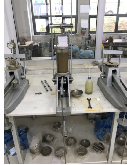
Şekil 4.14. Hücresine koyulan numunelerin 75 kPa düşey gerilme altında yeniden oluşturulması
