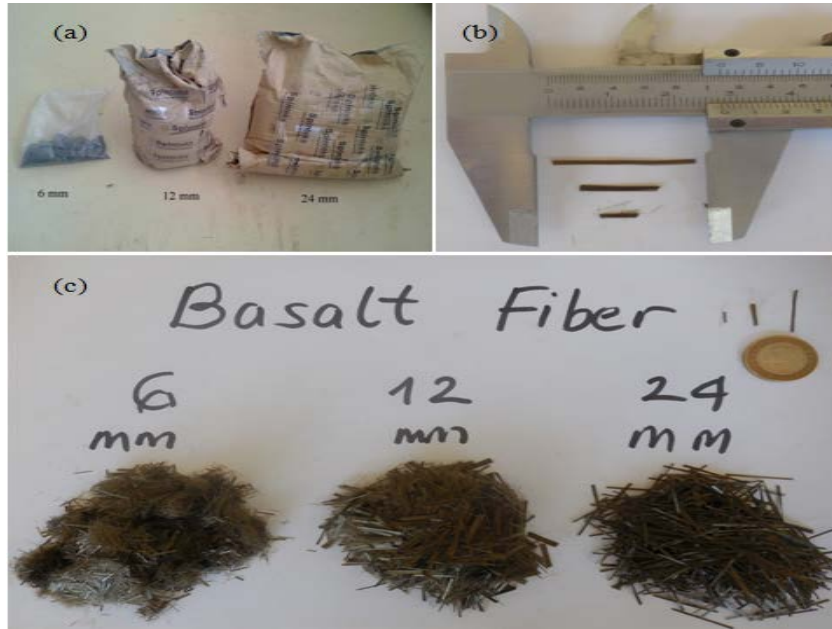
Şekil 4.4. Bazalt fiberler (a) torbalanmış bazalt fiberler, (b ve c) değişik uzunluklardaki bazalt fiberler (Ndepete ve Sert, 2017)
