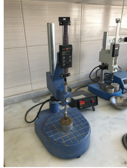
Şekil 4.6. Konik penetrometre deneyi yapılışı
