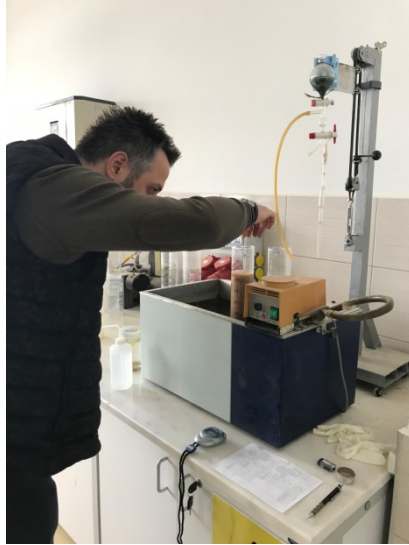
Şekil 4.11. TS 1900/2006-1'e göre yapılan elek analizi, hidrometre ve pipet deneylerine ait fotoğraflar
