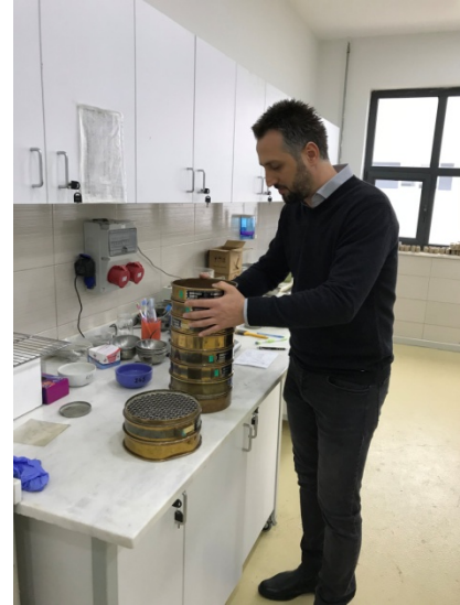
Şekil 4.11. TS 1900/2006-1'e göre yapılan elek analizi, hidrometre ve pipet deneylerine ait fotoğraflar
