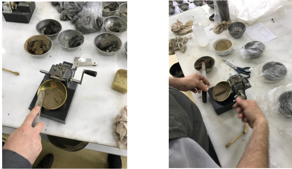
Şekil 4.5. Siltli zemin için Casagrande deneyine ait görüntüler
