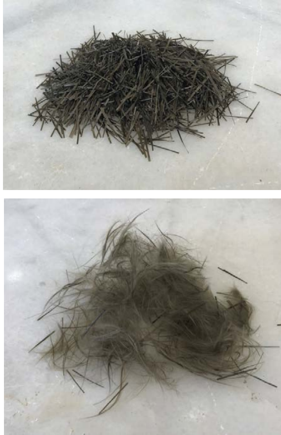
Şekil 4. 12. Bazalt liflerinin ayrıştırılmadan önce ve ayrıştırıldıktan sonraki hali
