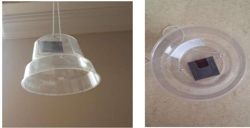
řekil 3.3. Radon Ölçümleri İçin Hazırlanan LR-115 Dedektörleri
