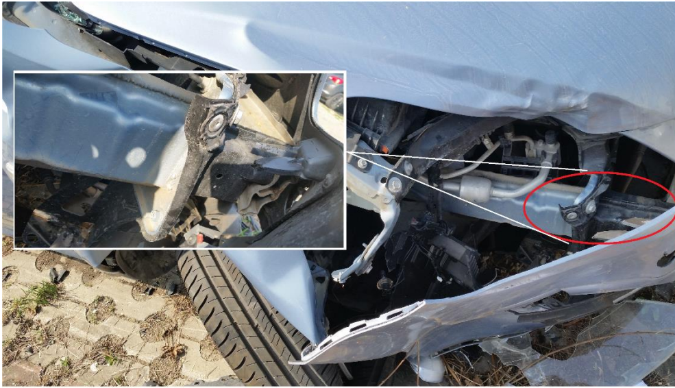
Şekil 5.4. Şasi ön ray bağlantısı
