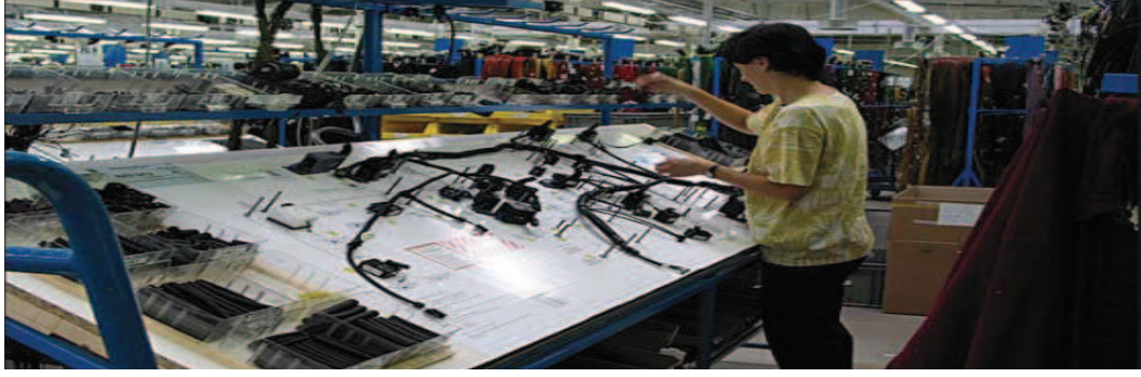
Şekil 4.13. Alttan beslemeli kablo tesisatı montaj çalışma tezgâhı çalışma durumu.
