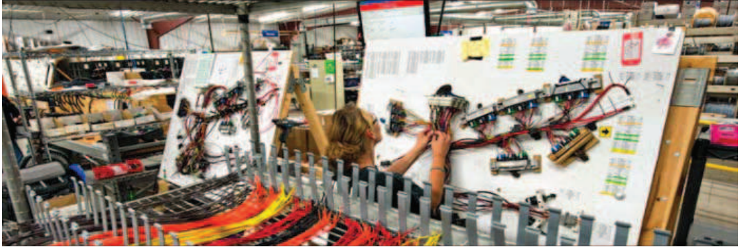
Şekil 4.8. Arkadan beslemeli kablo tesisatı montaj çalışma tezgâhı genel durum.
