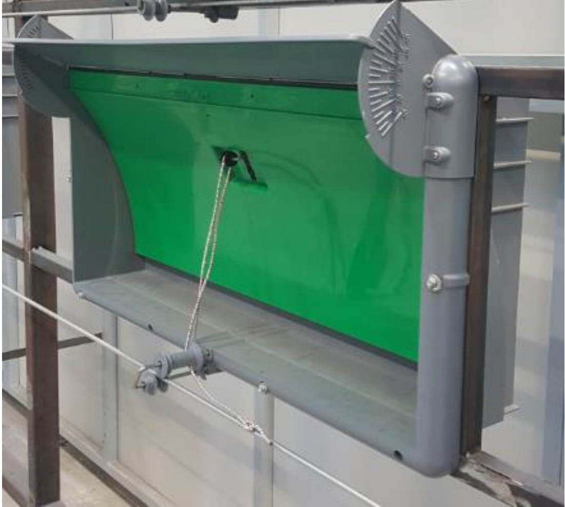
Şekil 4.35. Kapağın test düzeneğine monte edilmesi
