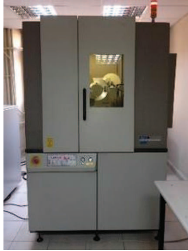
Şekil 4.3. Rigaku (D/Max/2200) X-ışını kırınım (XRD) cihazı.
