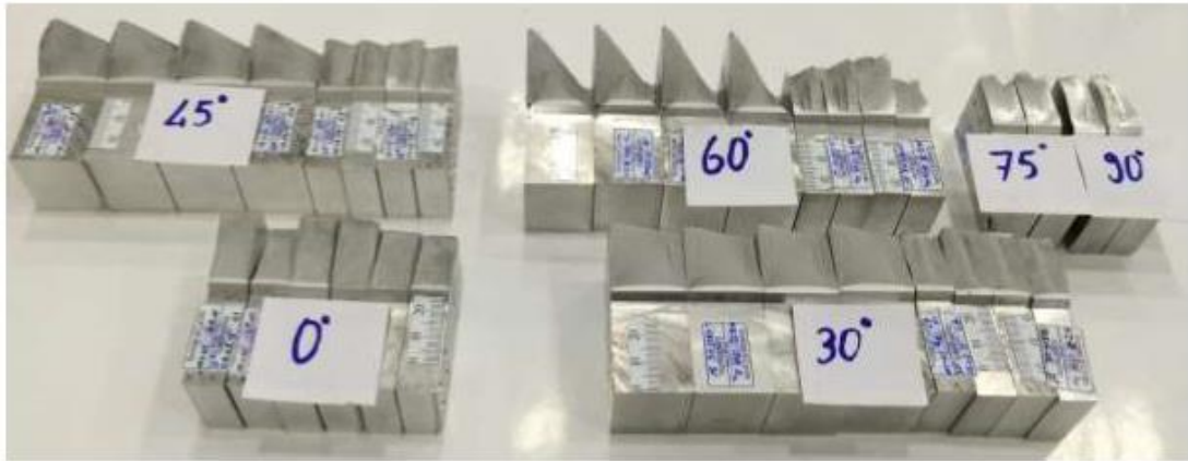
Şekil 4.14. Mod-I/III testleri sonrası numunelerin genel görünümü [10].
