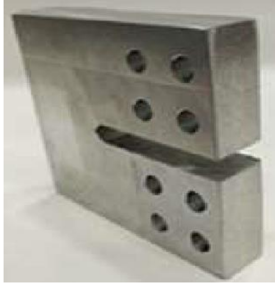
Şekil 4.4. 12,5 mm kalınlıktaki mod-I/III CTT numunesi
