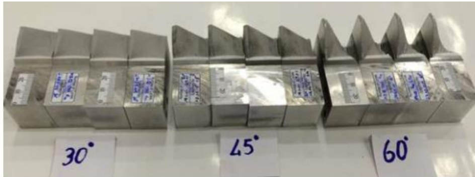
Şekil 4.18. Farklı açılarda kırılma tokluğu deneylerinde kullanılan bazı numuneler [10].
