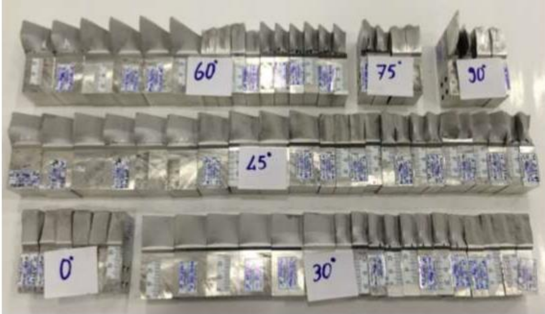
Şekil 4.23. Mod-I/III testlerinde kullanılan tüm numunelerin üstten görünüşü. [10]
