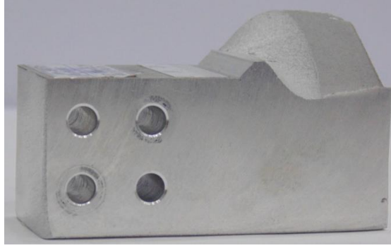
Şekil 4.26. CTT numunenin çatlak ilerleme testinden sonraki yarım model perspektif görünüşü
