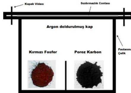
Şekil 2.7. Termal buhar biriktirme yöntemi ile P@Karbon kompoziti hazırlama aparatı [51].
