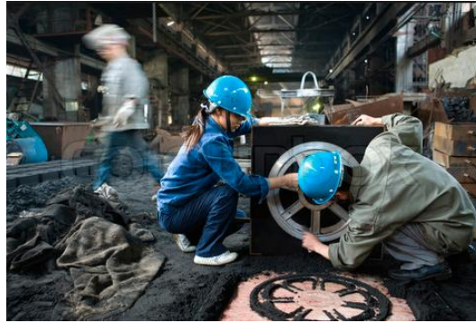
Şekil 2.4. Kum kalıba döküm yöntemi ile jant üretimi.
