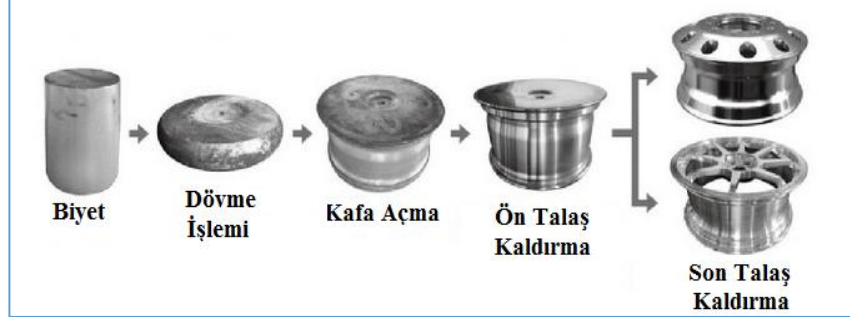
Şekil 2.3. Dövme ile jant üretimi işlem basamakları.
