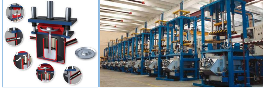
Şekil 2.5. Düşük basınçlı döküm yöntemi ile seri halde jant üretimi.
