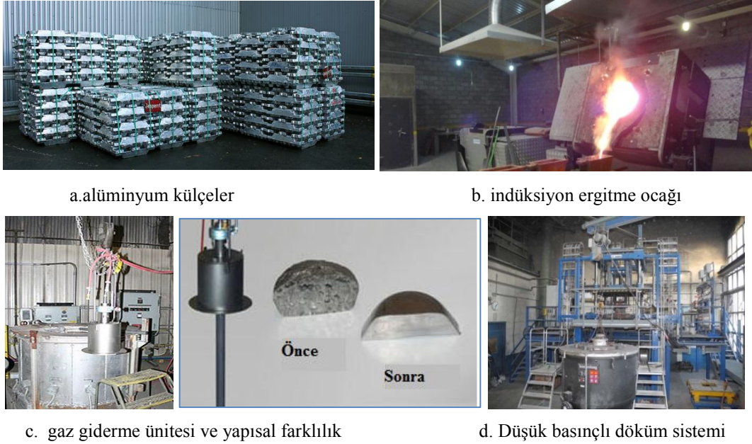
Şekil 3.2. Alüminyum jant döküm sistemi.
