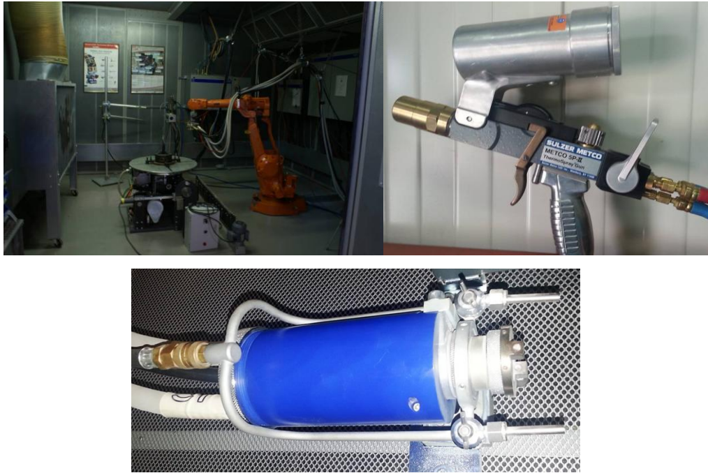
Şekil 6.3. Termal sprej multi tabanca kabini, alev sprej tabancası ve plazma sprej tabancası.
