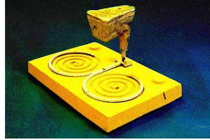
Şekil 4.5. Double-spiral akışkanlık testi sematik gösterimleri[39].
