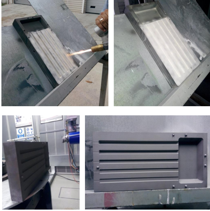
Şeki 7.15. Sıvı metal akışkanlık test kalıbının alev sprey kaplama prosesi ile kaplanması.
