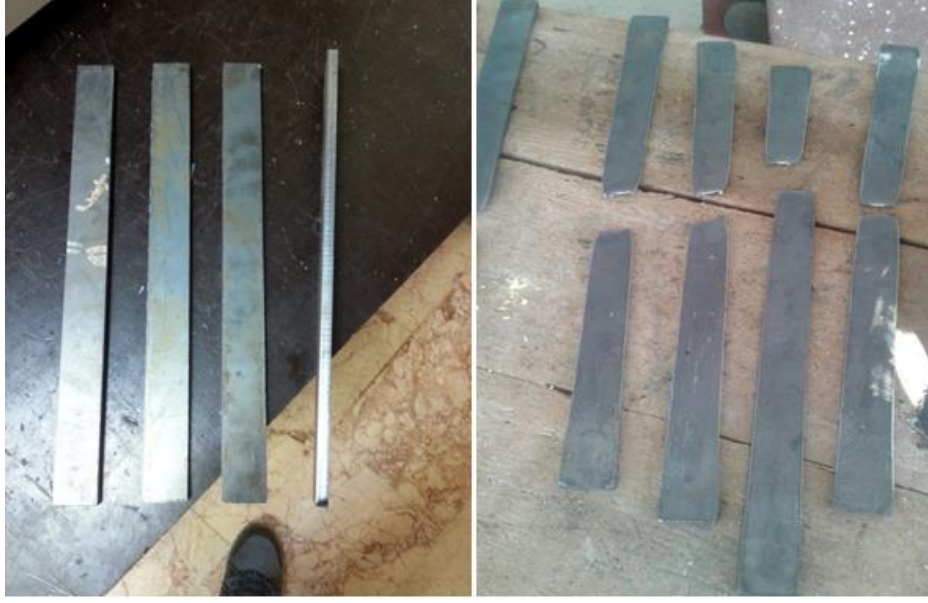
Şekil 3.14. IPE240 profile ait flans kopma deney numuneleri
