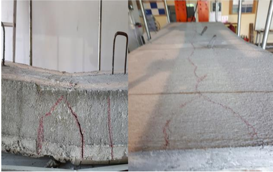
Şekil 3.54. DN5-2S-D120 numuneye ait ön ve üst çatlak görüntüleri
