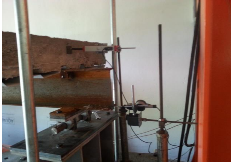
Şekil 3.29. Tüm numuneler için uzama ve kışalma ölçüm cihazları
