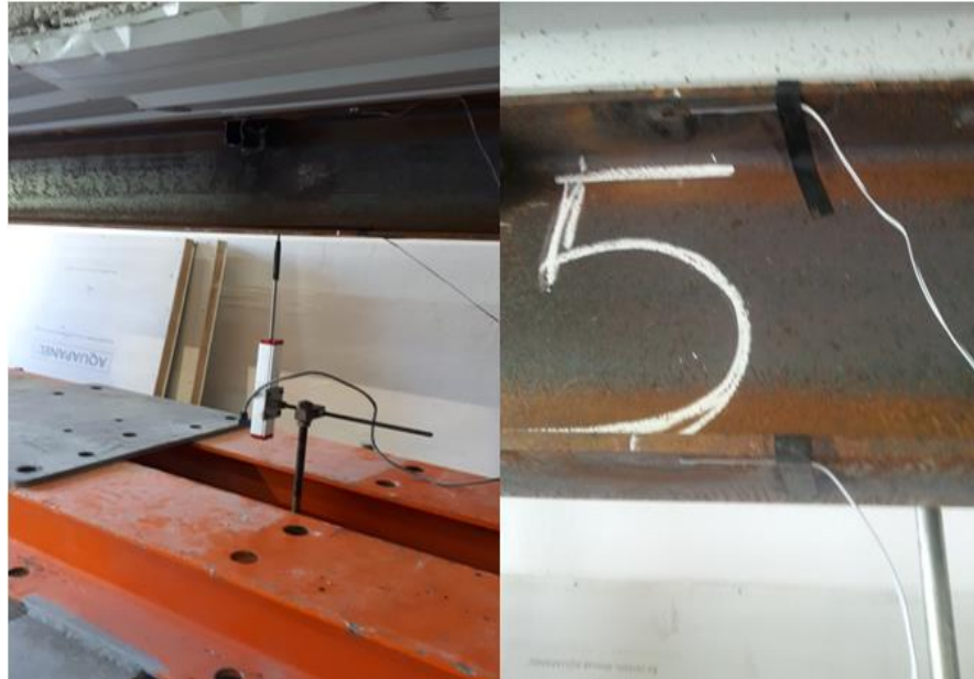
Şekil 3.28. Tüm numuneler için deplasman ve şekildeğiştirme ölçüm cihazları
