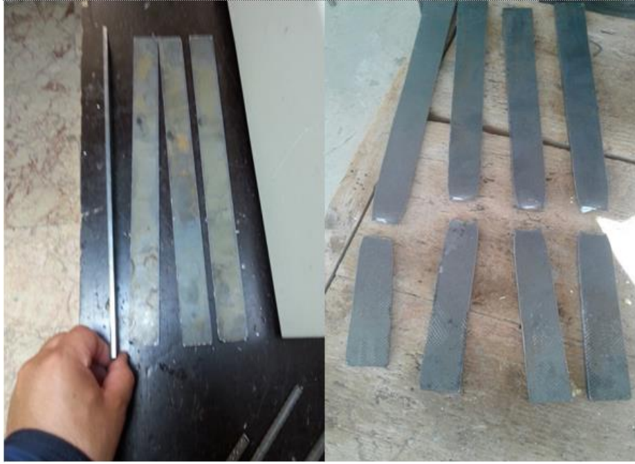
Şekil 3.16. IPE240 profil ait gövde kopma deney numuneleri
