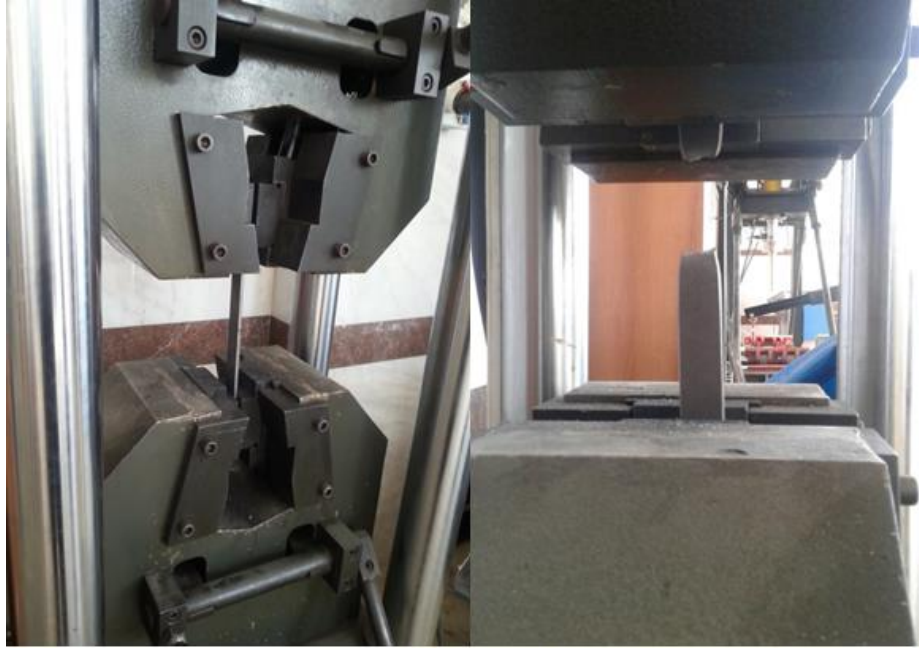
Şekil 3.15. Gövde plaka çekme deney numuneleri
