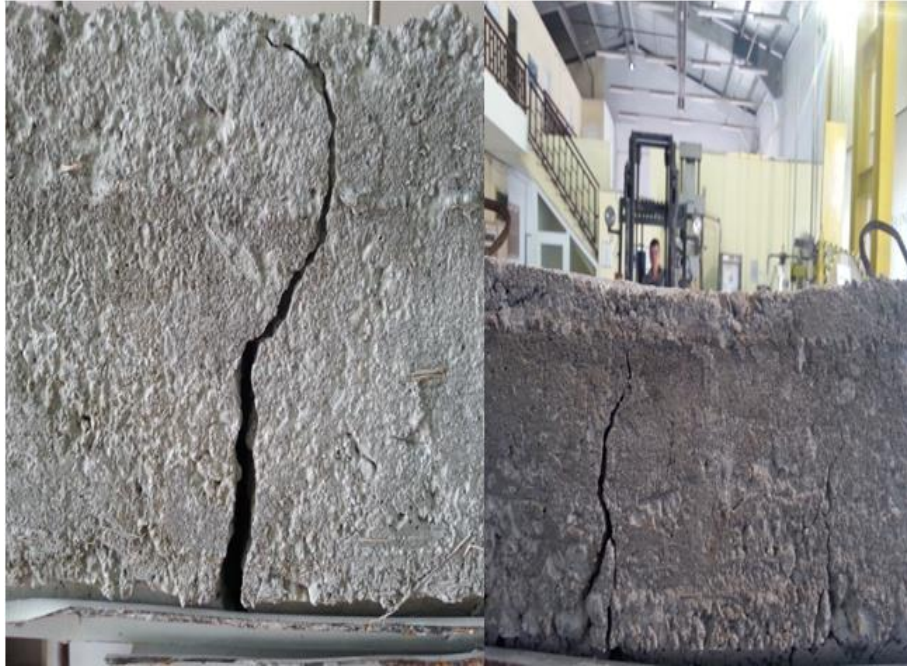
Şekil 3.60. DN6-2S-D150 numuneye ait ön ve arka çatlak görünüşleri
