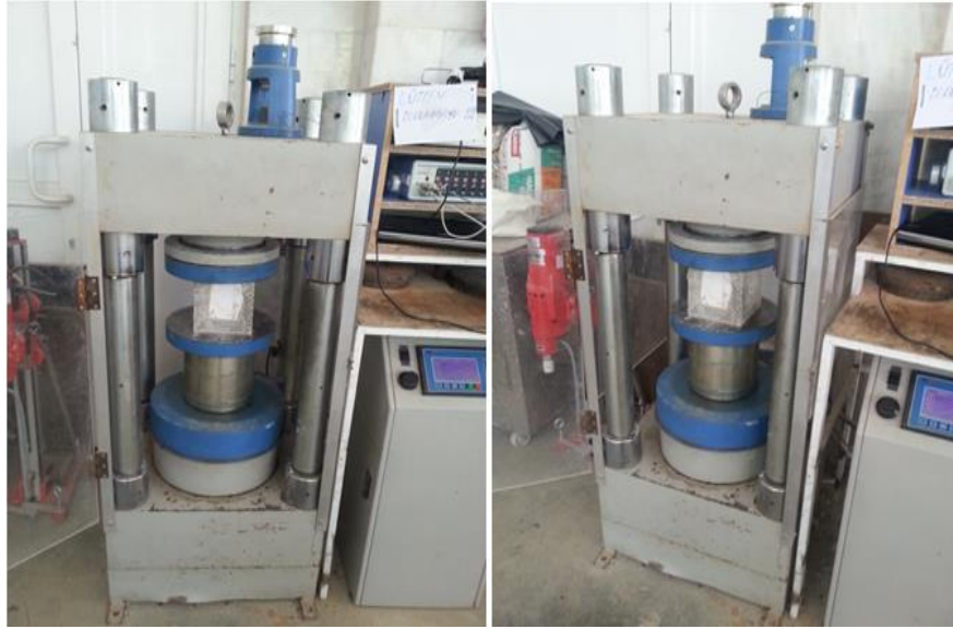
Şekil 3.5. 28 günlük beton basınç dayanımı
