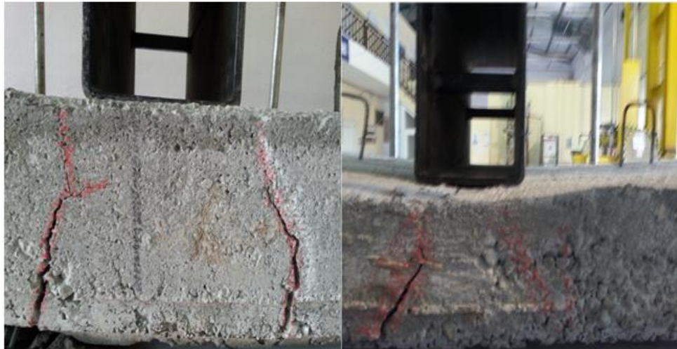
řekil 3.36. DN2-1S-D120 numuneye ait n ve arka atlak grnřleri
