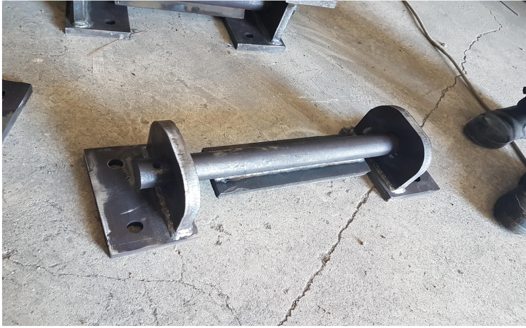
Şekil 4.7. İmalatı yapılan mesnet parçasının birinci kısmı
