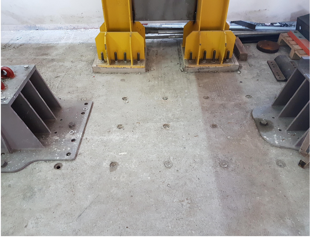
Şekil 4.12. Laboratuvardaki yeni konumuna getirilen mesnetler
