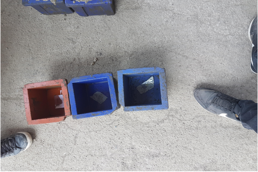
Şekil 4.2. Beton numunelerin kalıpları
