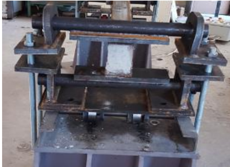
Şekil 4.10. İmalatı yapıp monte edilen mesnet
