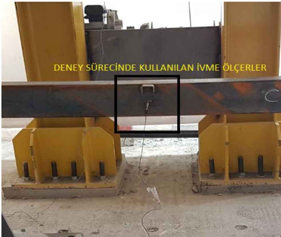
Şekil 4.14. Numune üzerine monte edilmiş ivme ölçerler
