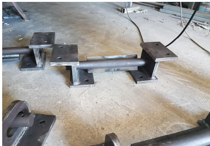
Şekil 4.8. İmalatı yapılan mesnet parçasının ikinci kısmı
