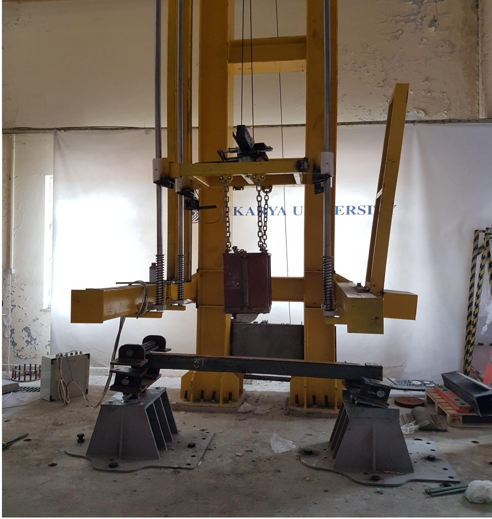
Şekil 4.22. Numunelerin deney düzeneğine sabitlenmesi
