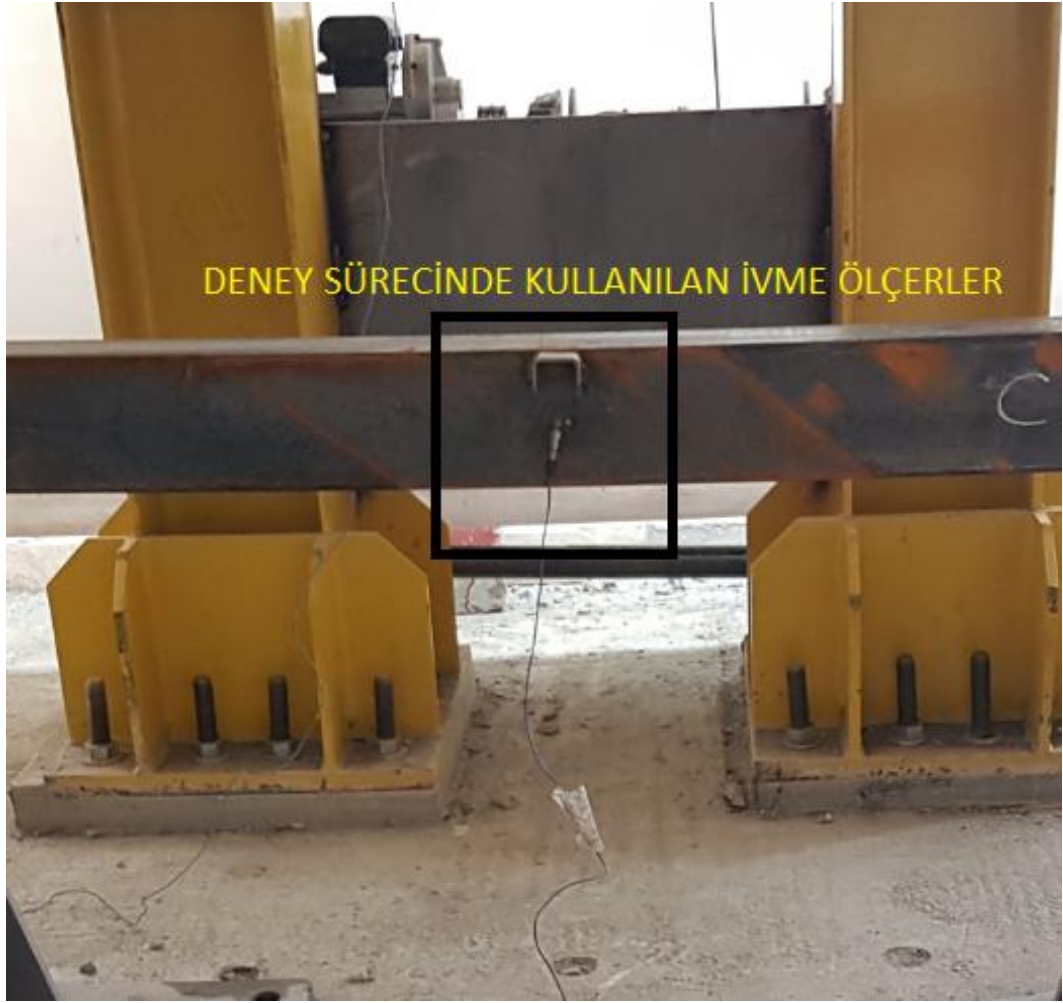
Şekil 4.24. İvme ölçerler profile sabitlenen somunlara monte edilmiştir.
