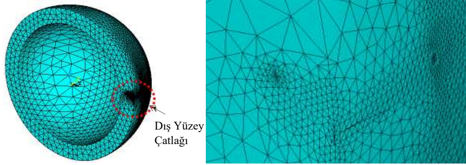
Şekil 3.56. R_o/R_i=1.25 , a/t=0.50 ve a/c=0.50 30 derece çatlak açısı için küresel kap ve kaptaki çatlakın sonlu elemanlar modeli.
