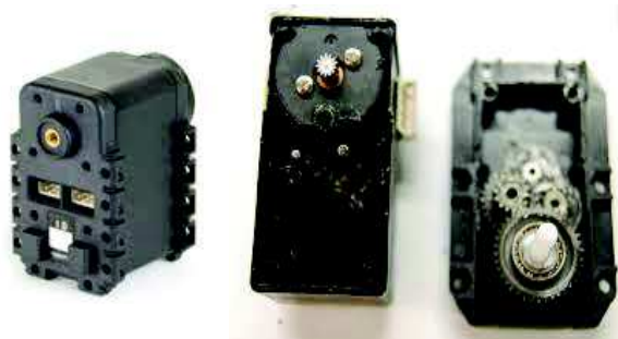
Şekil 3.6. Dynamiel AX-12A servo motor arkadan görünüşü ve redüktör grubu [34].
