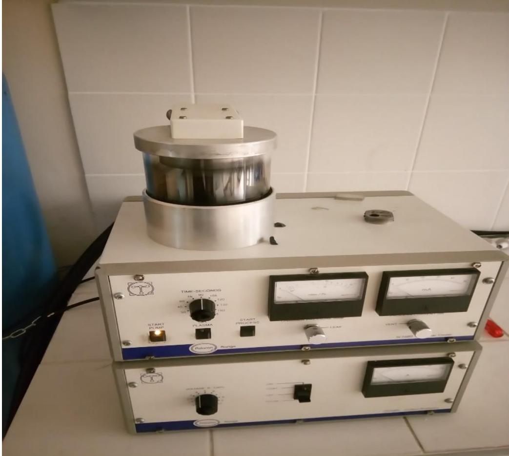
Şekil 3.10. Numunelerin 5 nm kalınlığında altın filmle kaplanması
