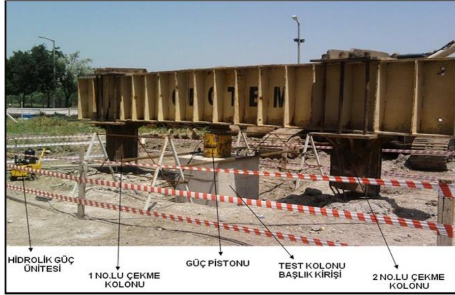
Şekil 3.19. Basit kolon yükleme deneyi (Tachir, 2015).
