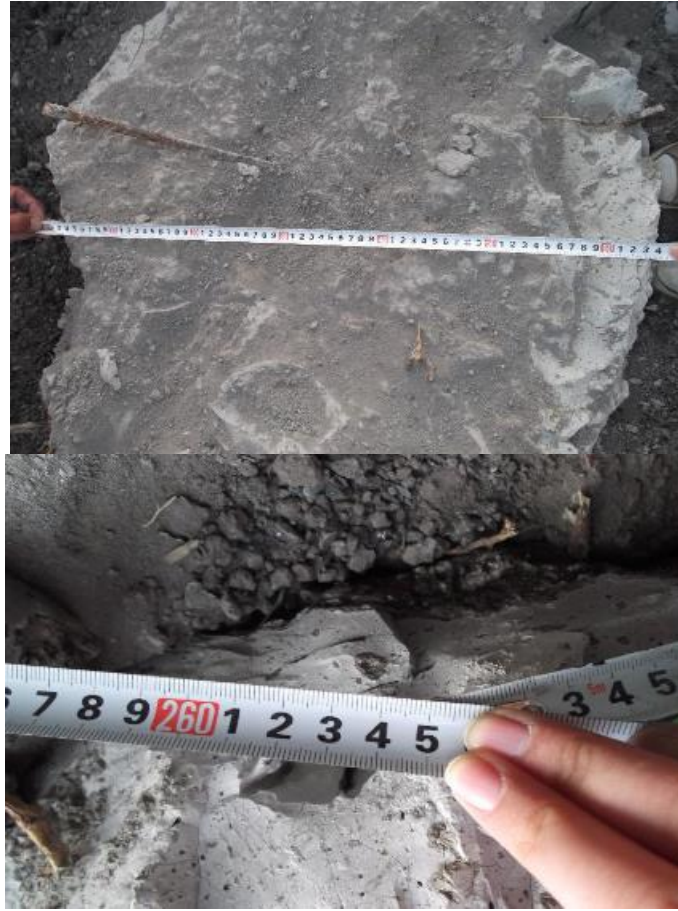
Şekil 3.16. Jet Grout deneme kolonu çap kontrolü (Çınar, 2014).
