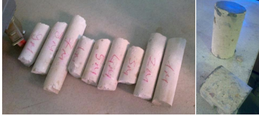
Şekil 3.18. Jet kolonlarından alınmış karot numunenin deneye hazırlanması
