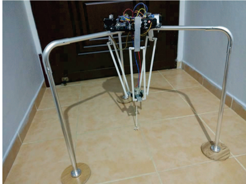
Şekil 4.3. Tasarlanan delta robot
