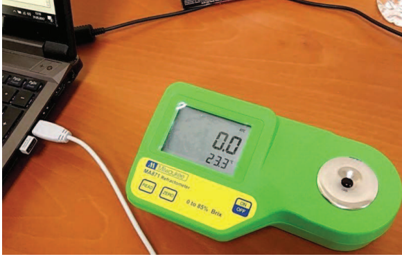
Şekil 5.1. Brix ölçerin saf su ile kalibrasyonunun yapılması
