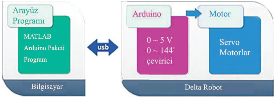
Şekil 4.4. Delta robot yazılımı blok diyagramı
