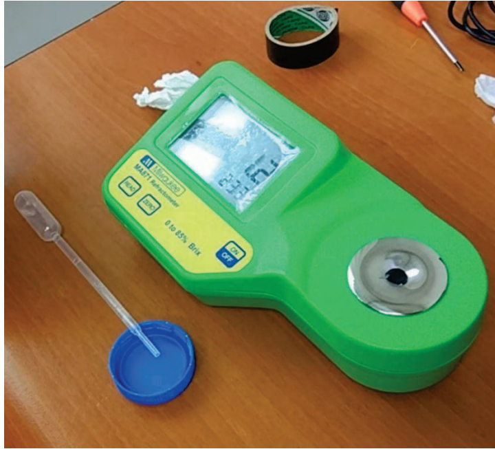
Şekil 5.10. Dairesel hareket ile 120 s karıştırılan çözeltinin şeker oranının brix ölçer ile ölçülmesi
