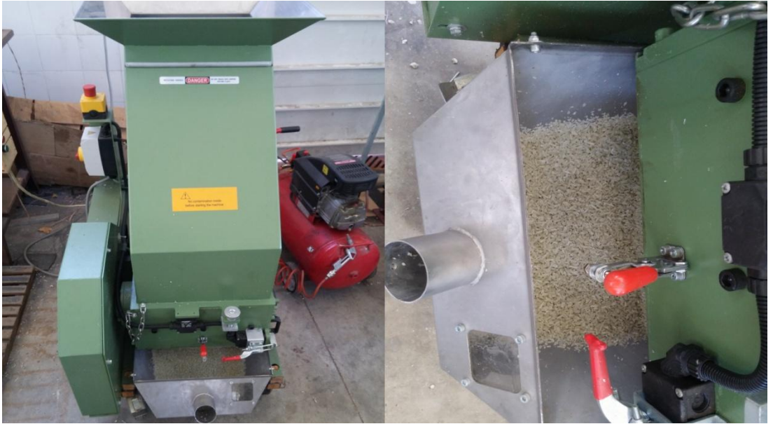
Şekil 3.10. Kırıcı cihazında kırılan kompozit granüller
