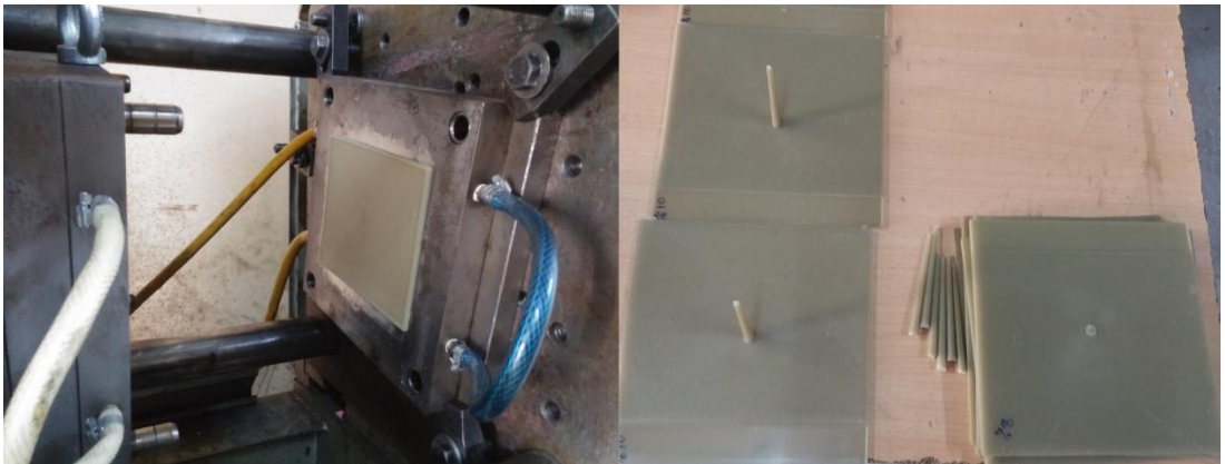
Şekil 3.12. Enjeksiyon cihazından çıkan kompozit plakaların gösterimi
