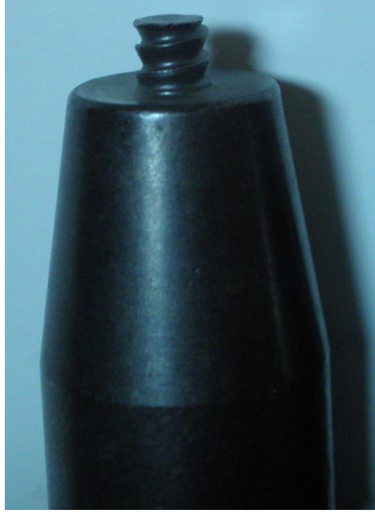
Şekil 5.3. Alüminyum alaşımlı levhaların SKK ile birleştirilmesinde kullanılan takım
