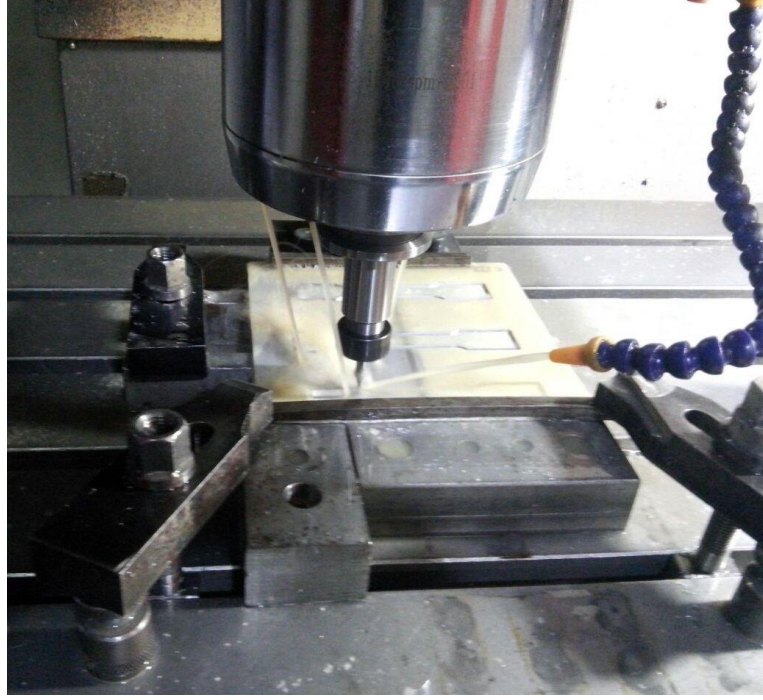
Şekil 5.2. Testerede plakalar halinde kesilen çekme deneyi numunelerinin CNC de işlenmesi
