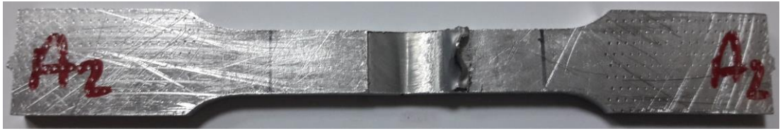
Şekil 7.8. 800/%2-2 Cu ,çekme deneyi sonrası kökten kopma
