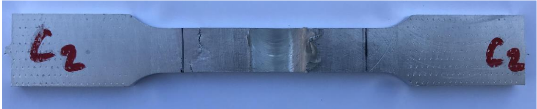
Şekil 7.9. 1200/%2-2 Cu Çekme deneyi sonrası, ana metalde meydana gelen kırılma örneğinin yüzey görünümü
