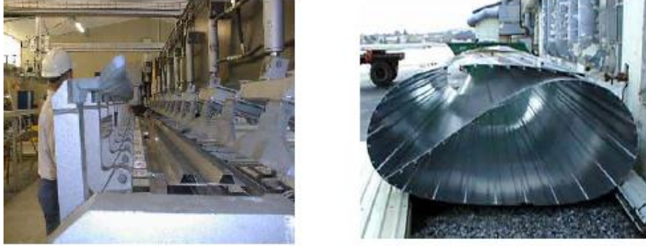
Şekil 3.13. Alüminyum panel ekstrüzyonları birleştirilmesi ve birleştirilmiş alüminyum panelleri
