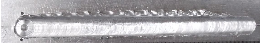
Şekil 7.1. SKK yöntemi ile birleştirilmiş Al- Cu levhaların genel yüzey görünümü
