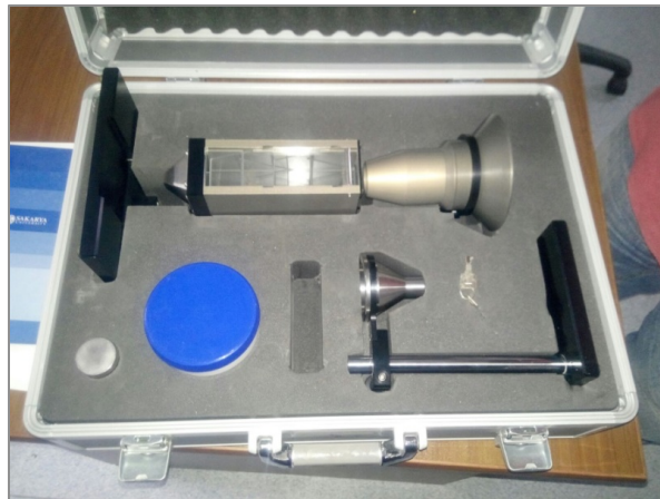
Şekil 5.8. HALL HF100 toz akış hızı ölçüm cihazı
