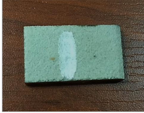
Şekil 6.8. CAS1 kodlu kaplamanın aşınma testi sonrası makro görüntüsü
