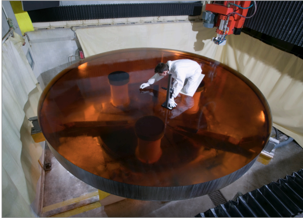
Şekil 2.20. Zerodur® cam-seramik teleskop aynası [61].
