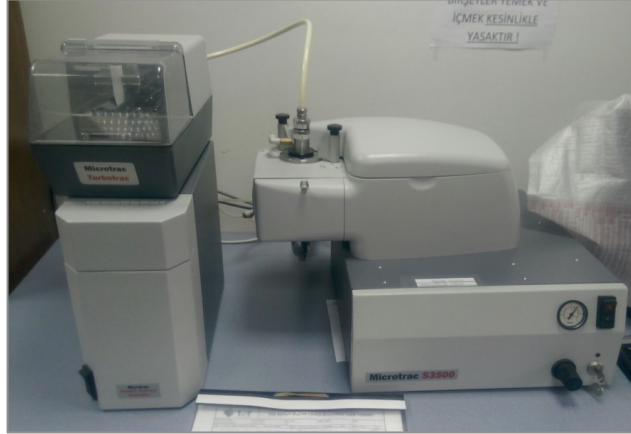
Şekil 5.9. MICROTRAC S3500 marka toz boyut analizi cihazı
