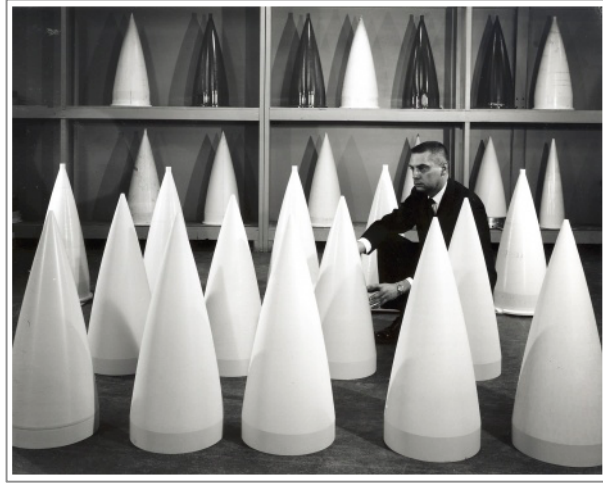
Şekil 2.19. Corning cam-seramik füze burun radomları [60].
