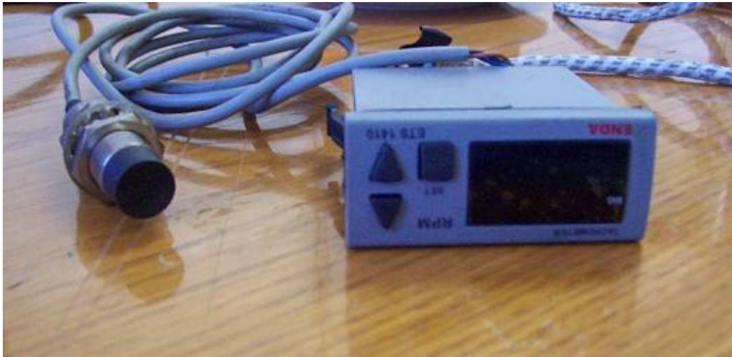
Şekil 5.7. Motor devir sensörü ve göstergesi
