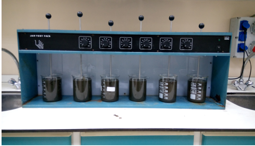
Şekil 3.4. Arıtma çamuru ve küllerin karıştırılması
