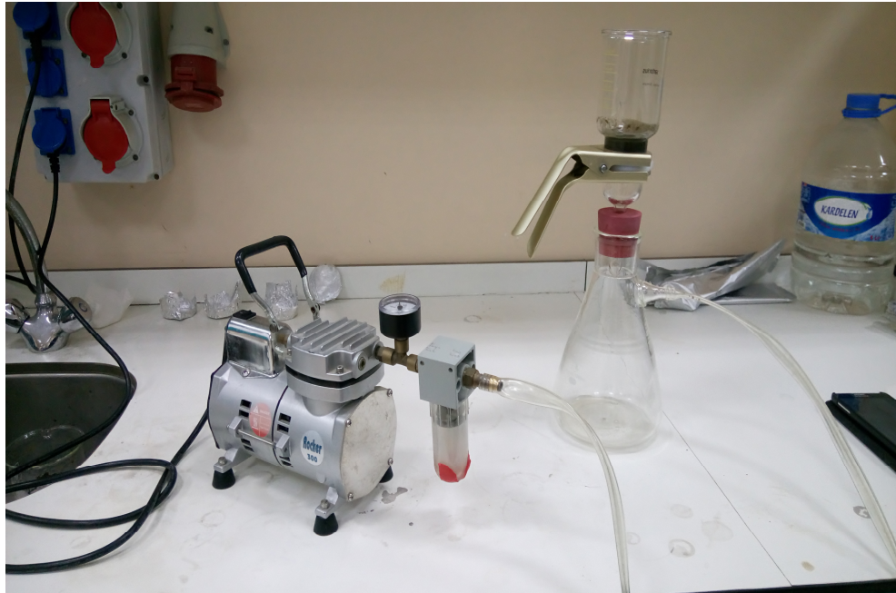
Şekil 3.9. Arıtma çamuru ve kül karışımlarının özgül filtre direncinin belirlenmesi
