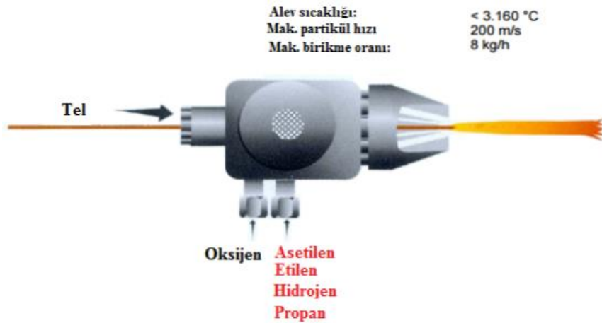
Şekil 2.6. Tel alev sprej yöntemi [8].
