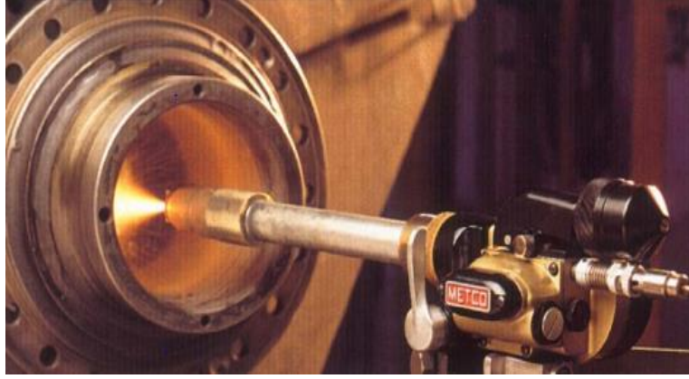
Şekil 2.7. Alev sprej kaplama uygulaması [8].
