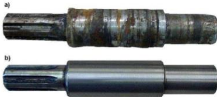
Şekil 3.8. a) İş parçası yüzeyinde kullanım sırasında oluşan aşınma. b) Elektrik ark spreyle kaplanarak tamir edilmiş iş parçası [35].
