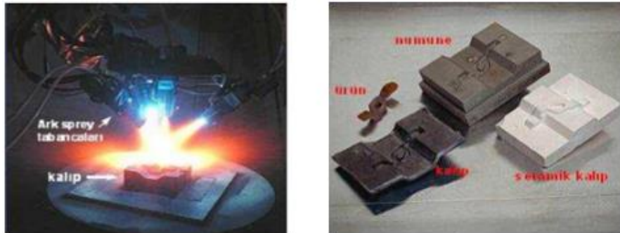
Şekil 3.12. Elektrik ark sprej yöntemiyle hızlı prototip kalıp üretimi ve üretilmiş kalıplar [35].
