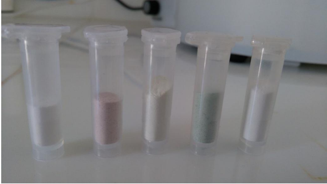
Şekil 4.5. Hazırlanan tozların görselleri soldan sağa sırasıyla \text{TiO}_2 , Fe katkılı \text{TiO}_2 , Ni katkılı \text{TiO}_2 , Co katkılı \text{TiO}_2 , Zn katkılı \text{TiO}_2
