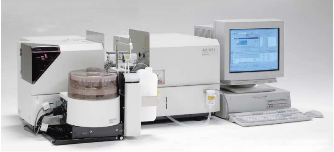
Şekil 4.1. Analizlerin yapıldığı Atomik Absorpsiyon Spektrofotometresi
