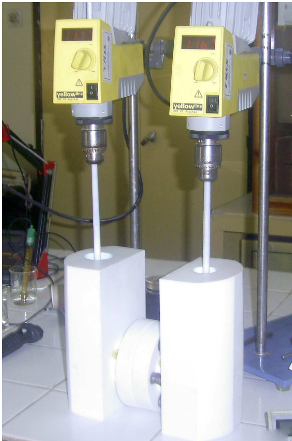
Şekil 4.3. Destekli sıvı membrana ait test hücresinin resmi
