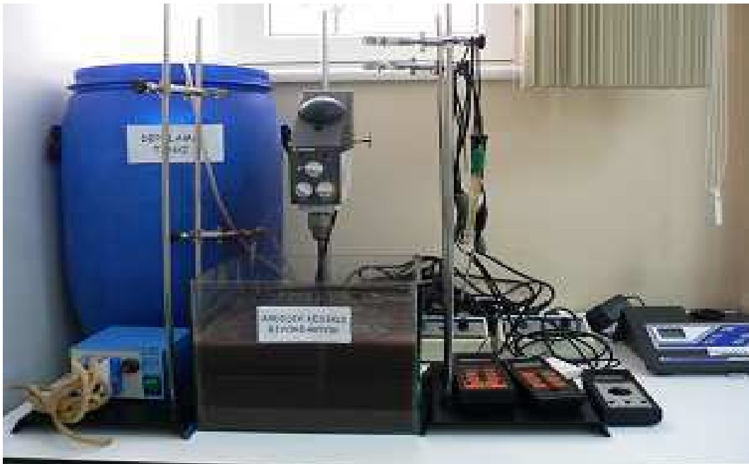
Şekil 3.2. Laboratuvar Ölçekli Ardışık Kesikli Reaktörün ve Kullanılan Teçhizatın Genel Görünümü
