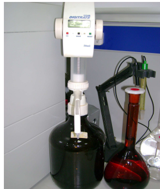
Şekil 3.9. KOİ Deneyinde Kullanılan Titrasyon Cihazı ve DAS Çözeltisinin Görüldüğü Resim
