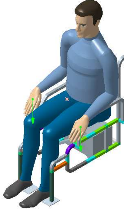
Şekil 2.21. Test mankeninin tekerlekli sandalyedeki konumlandırılmış CAD modeli
