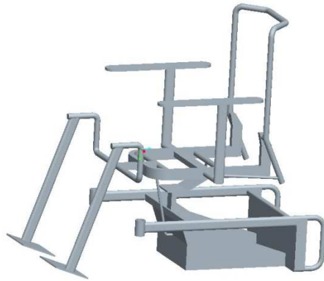
Şekil 2.16. Tekerlekli sandalyenin detaylı şasi CAD modeli
