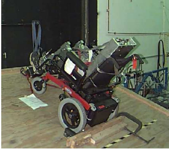
Şekil 1.7. Yokuş yukarı statik kararlılık test görüntüsü[2]
