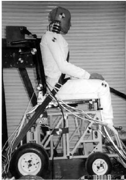
Şekil 1.33. Kızaklı çarpışma test düzeneğinin “yolcu emniyet kemerinin, kızak düzeneğine bağlanmış sistemi” için hazırlanma şekli[53]
