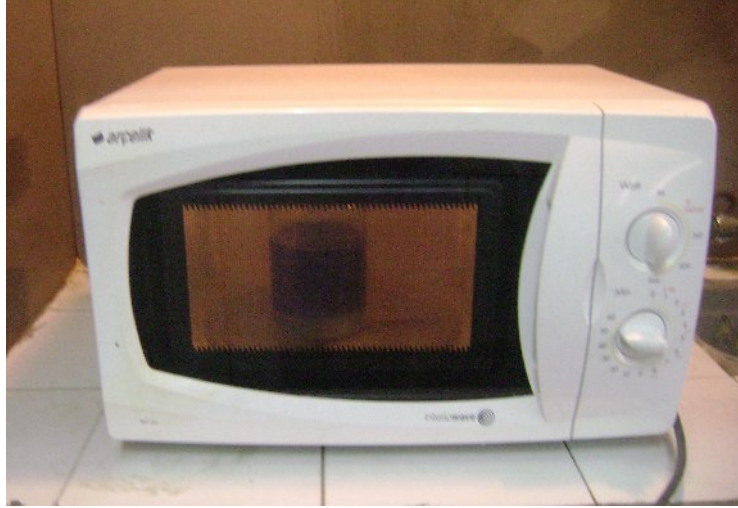
Şekil 5.5. Mikrodalga ile klinoptilolit vanadyum iyon değişimi
