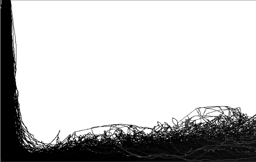
Şekil 3.3. 2.56 kg/m 2 s sıvı kütle akısında ve 24.9 m/s hava hızında damlacıkların yörüngeleri
