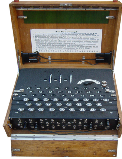
Şekil 3.4. Alman ordusunun kullandığı “Enigma” şifreleme cihazı [44].
