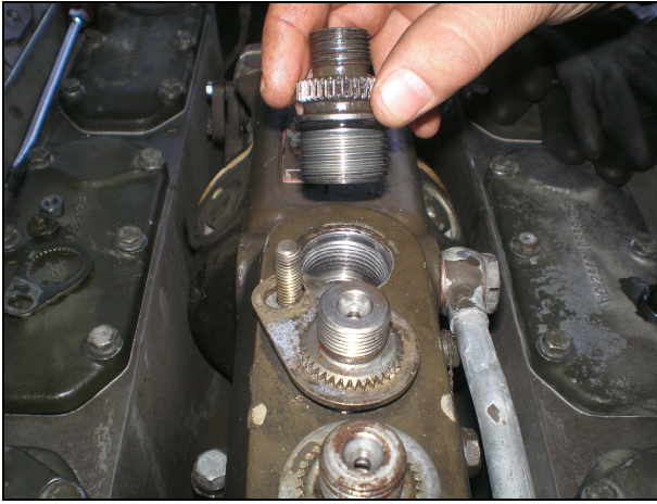
Şekil 6.9. Yakıt pompa elemanının sökülmesi
