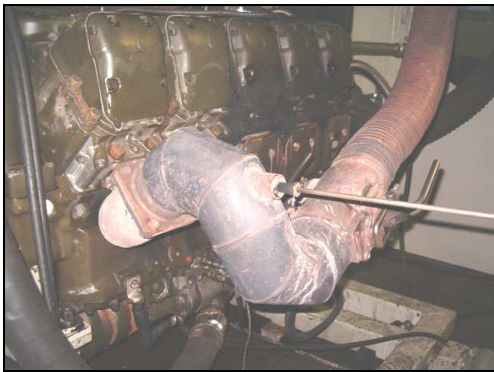
Şekil 6.15. Egzoz emisyonunun ölçülmesi
