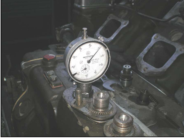
Şekil 6-10. Komparatör saatinin takılması
