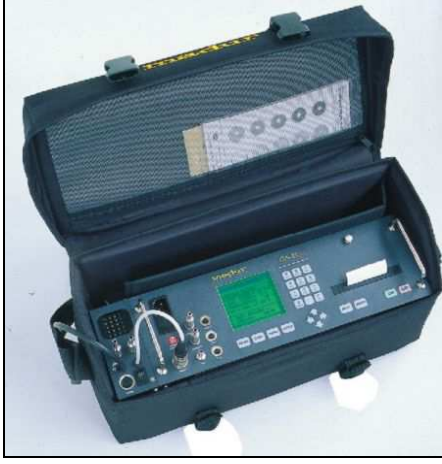
Şekil 6.14. Egzoz emisyon ölçüm cihazı
