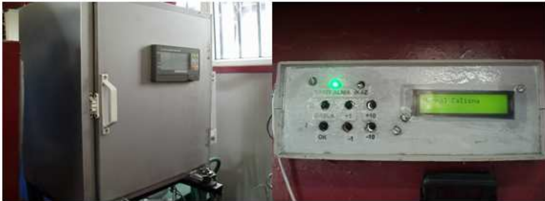
Şekil 4.14. Kütleleel yakıt ölçüm düzeneği
