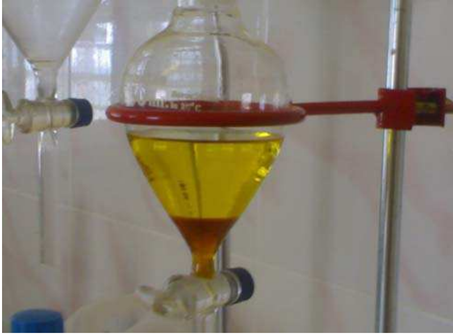
Şekil 4.6. Ayırma hunisinde TTYME – gliserin ayrışması
