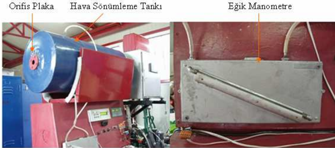
Şekil 4.13. Hava debisi ölçümü için kullanılan eğik manometre ve sönümlenme tankı
