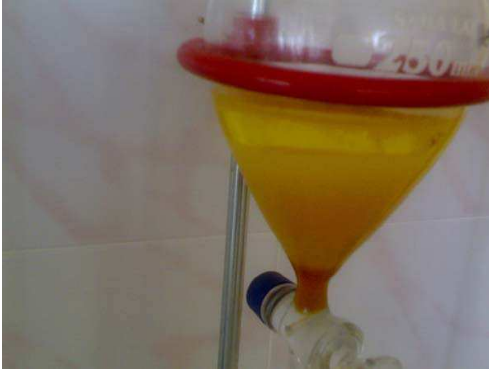
Şekil 5.10. % 1.5 NaOH katalizörü ve 1/5 molar oranında ayırma hunisinde sabun oluşumu
