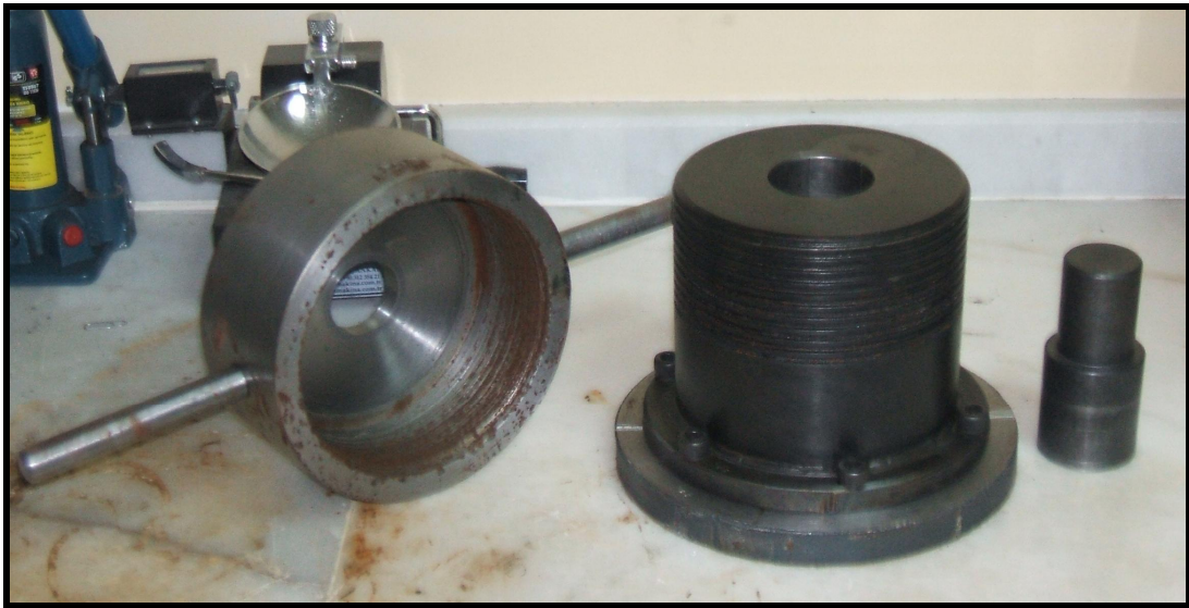
Şekil 3.28. Beton sıkıştırma kalıbını oluşturan parçalar
