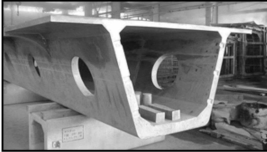
Şekil 2.13. Sakata-Mirai RPB kullanılarak yapılan yaya köprüsü kirişleri [37].
