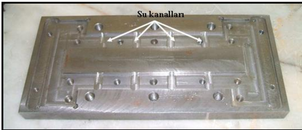
Şekil B.2. Kalıbın yan ve alt parçalarına açılan su çıkış kanalları
