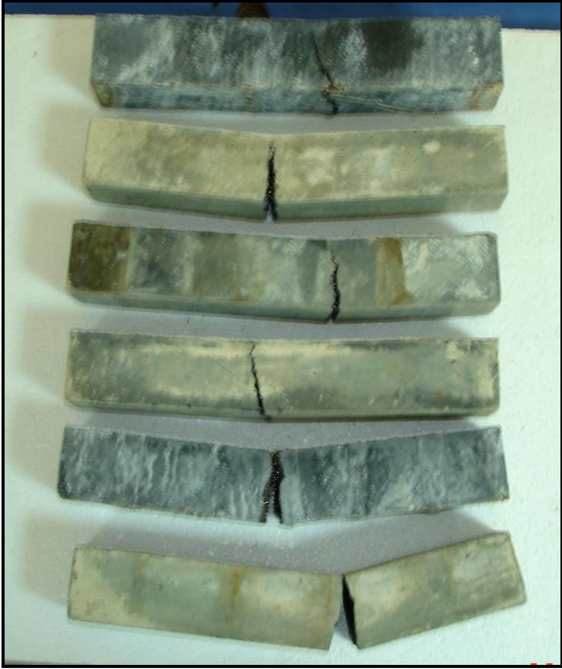
Şekil C.2. Eğilme deneyi sonucu kırılmış Şahit ve lifli içeren numuneler
