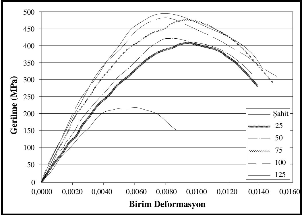
Şekil C.11. Sıkıştırma basıncı uygulanmış numunelere ait gerilme-deformasyon grafikleri
