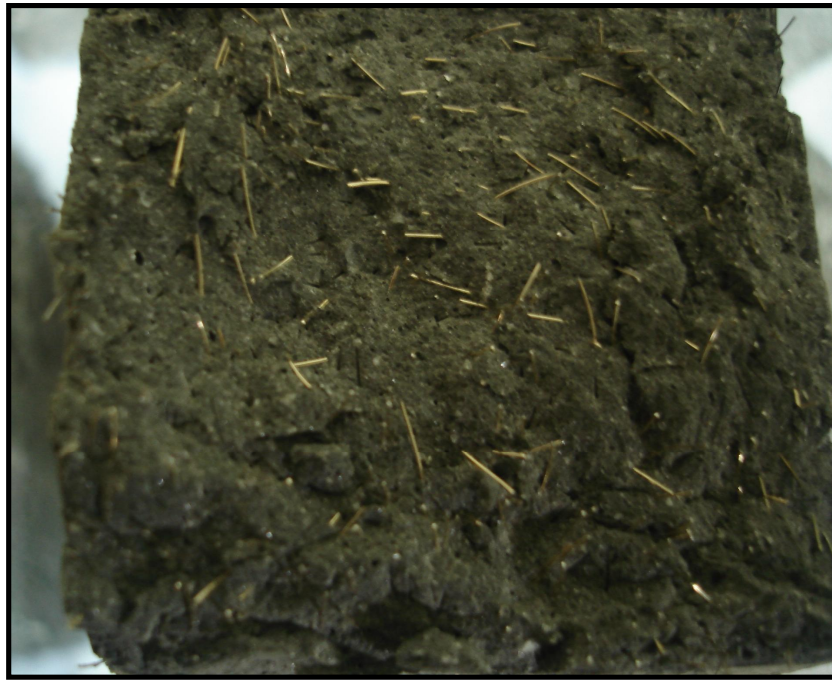
Şekil 4.52. Eğilme deneyi sonucu liflerin sıyrılarak beton içerisinden çıkması
