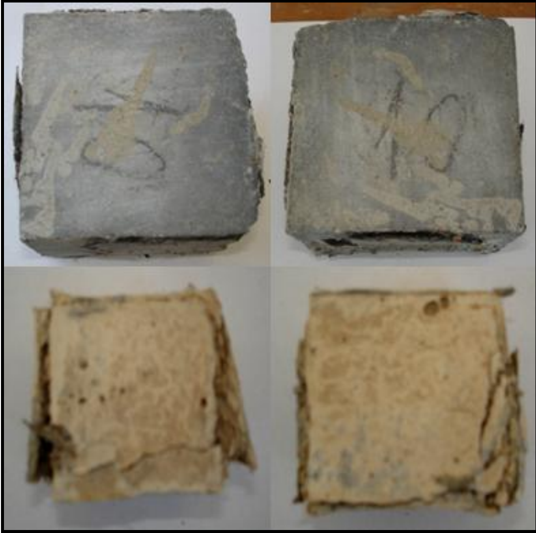
Şekil 3.26. Termal gerilmeler sonucu zarar görmüş numuneler
