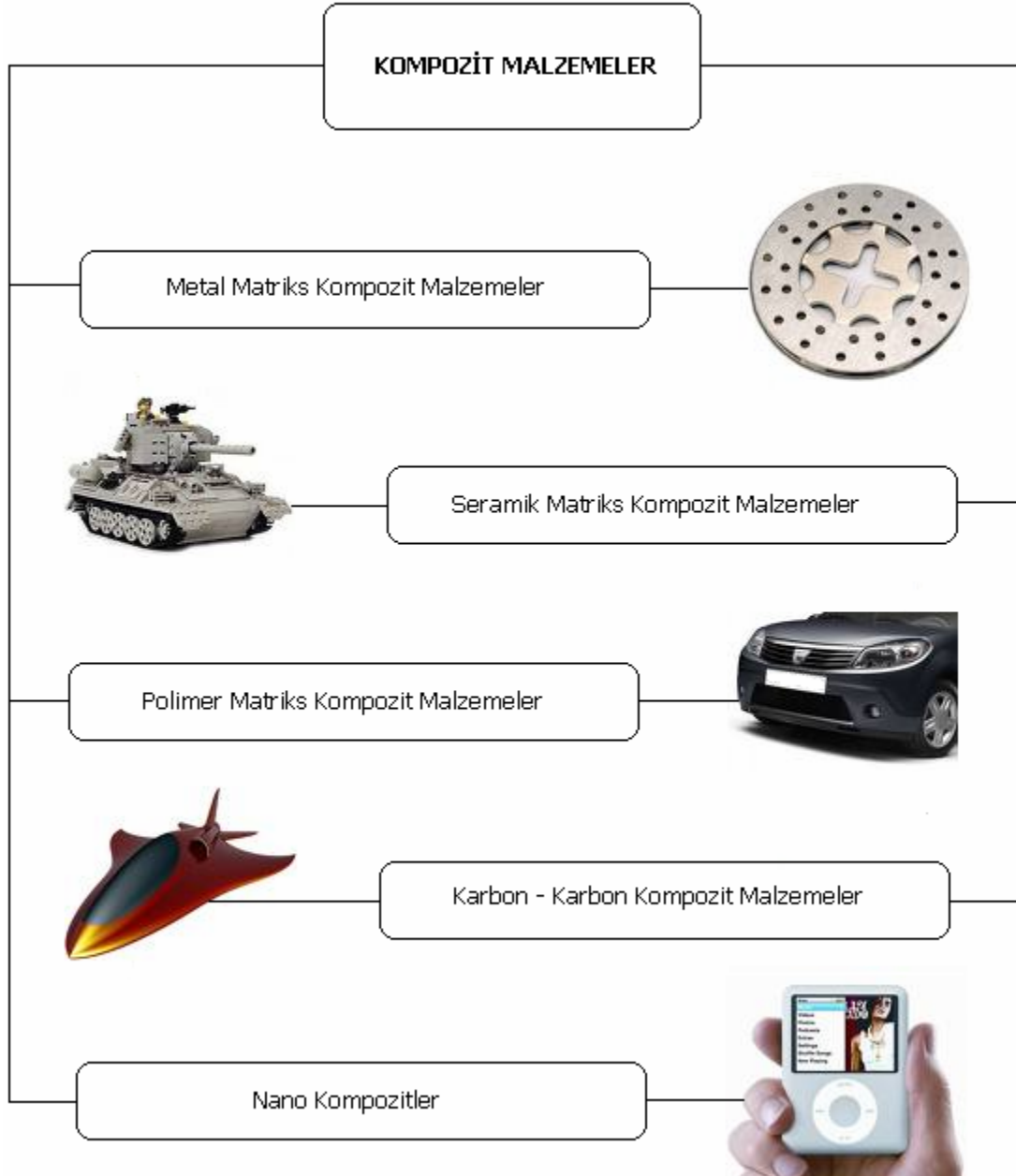
Şekil 2.3. Kompozit malzemelerin kullanılan matriks malzemesinin cinsine göre sınıflandırılması (Akbulut, 1995; Altınkök, 2002; Kurnaz, 1993; Şahin, 2002; Yılmaz, 2007).
