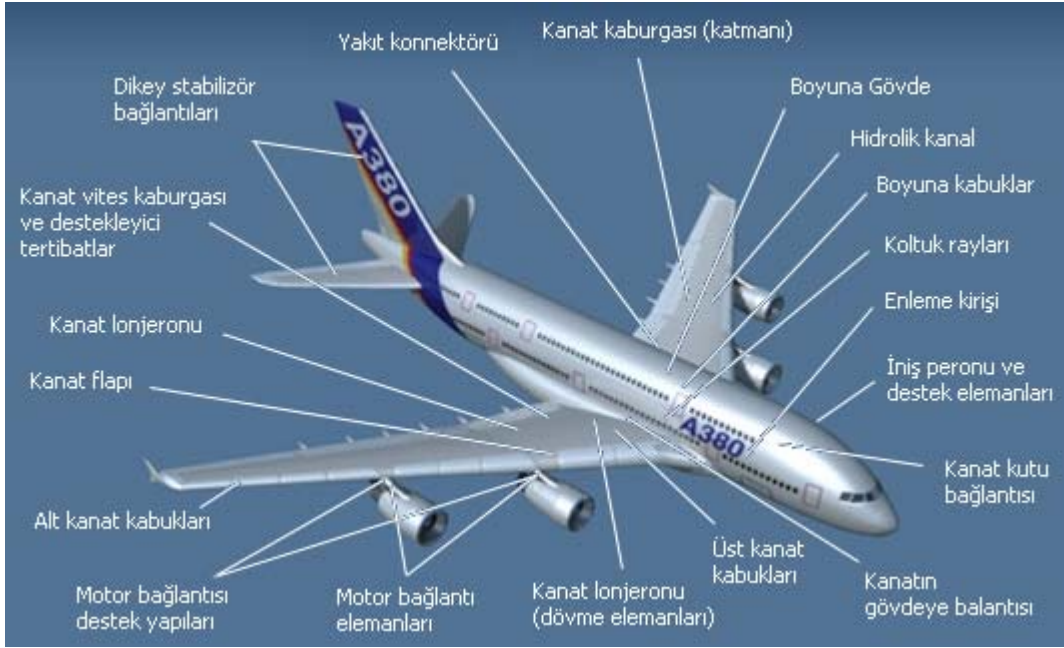
Şekil 3.34. A380 uçağında kullanılan alüminyum ve kompozitlerinin kullanımı (www.alcoa.com)
