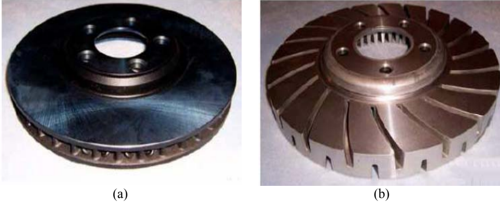
Şekil 3.29. (a) 4 kapılı bir sedan otomobilde kullanılan, gri dökme demirden imal edilen fren diski, (b) aynı otomobil için özel olarak tasarlanan, Al-SiC kompozit malzemeden imal edilen fren diski prototipi ( www.eere.energy.gov )
