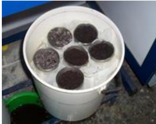
Şekil 3. 4. Saturasyondan alınan numunelerin kum kovaşına konulması
