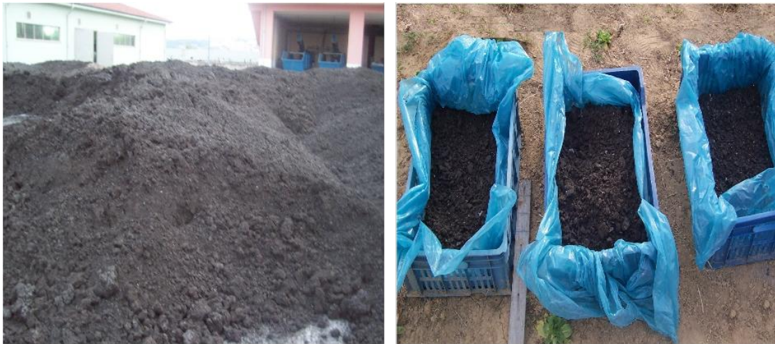
Şekil 3.10. Arıtma çamuru ve çamur kurutma işlemi
