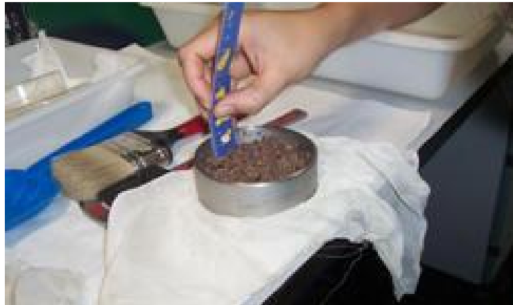
Şekil 3. 8. Kurutulan numunenin ne kadar çöktüğünün ölçülmesi
