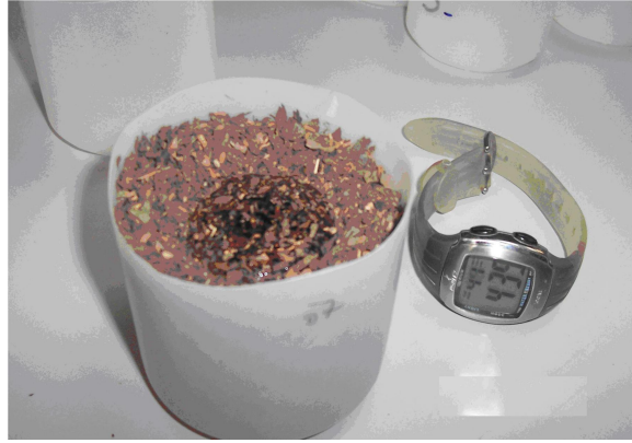
Şekil 3. 7. Fındık zürufu numunelerinin yeniden su çekmesinin belirlenmesi
