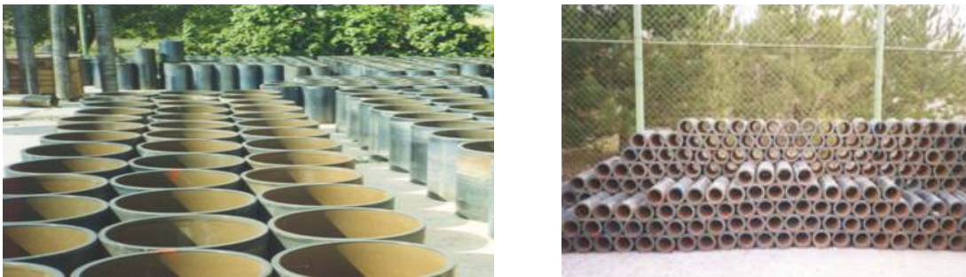
Şekil 3.28. Boru şeklinde üretilen bazalt cam-seramikleri [100]
