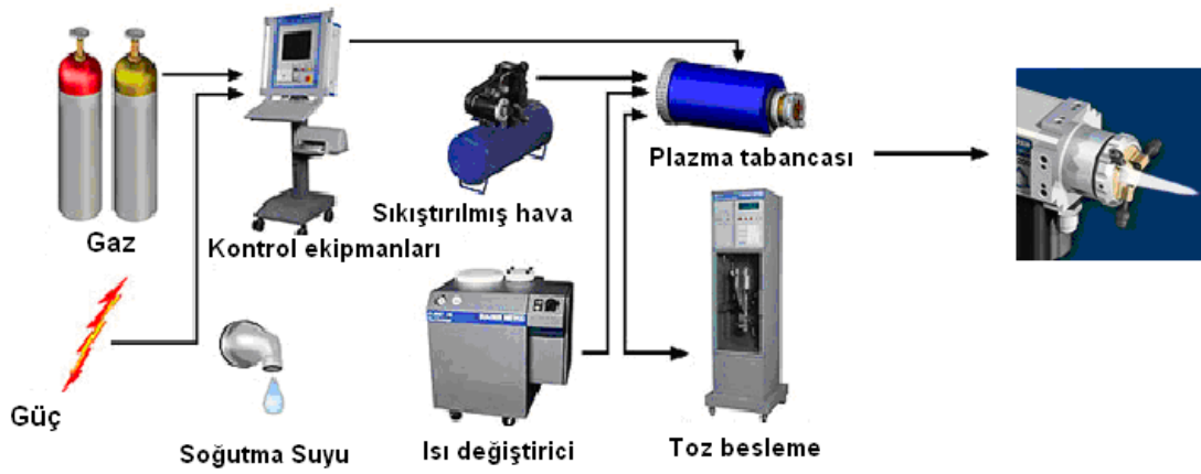
Şekil 4.18. Plazma tabancası ve kaplama prosesinde kullanılan ekipmanlar [111]
