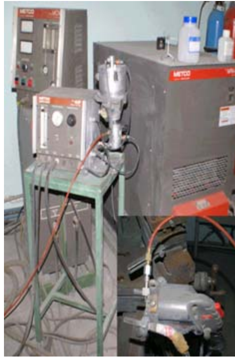
Şekil 5.5. METCO 3M Metco Perkin Elmer, 3MB II atmosferik plazma sprej kaplama ünitesi
