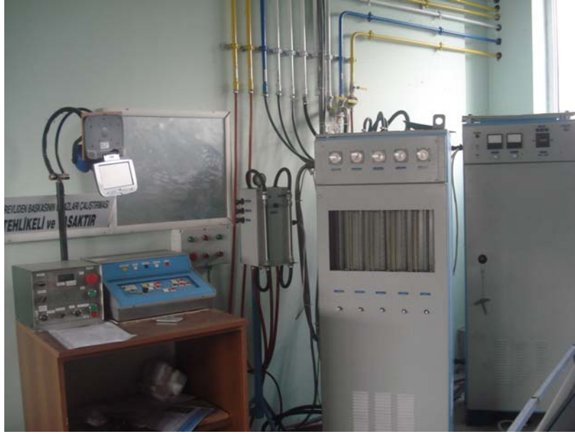
Şekil 7.1 a) Pulse plazma uygulama sistemi (plazmatron), b) kontrol paneli ve güç üniteleri
