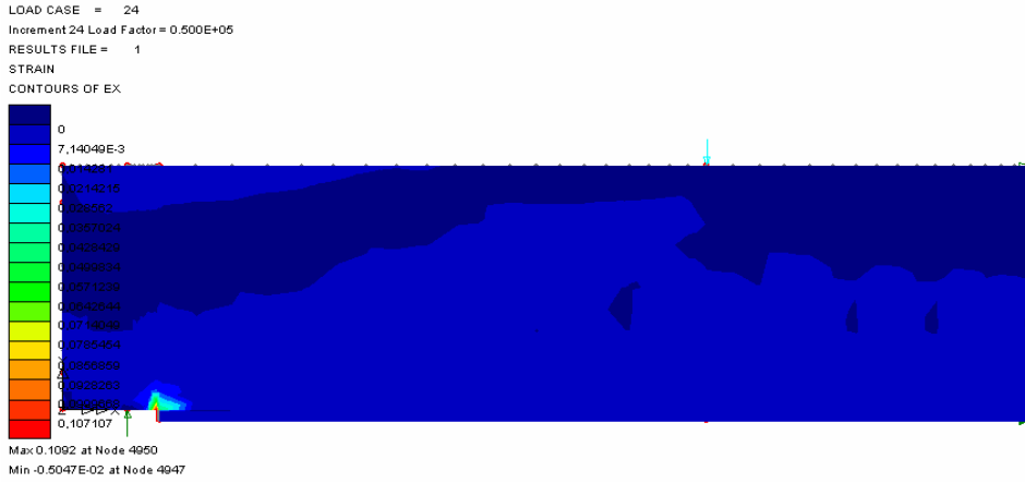
Şekil 5.37. A3 tipi sayısal kiriş modelinde meydana gelen birim zorlanma( \epsilon_x ) değerleri değişimi
