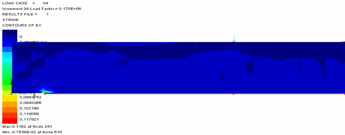
Şekil5.66. B2 tipi sayısal kiriş modelinde meydana gelen birim zorlanma( \epsilon_x ) değerleri değişimi
