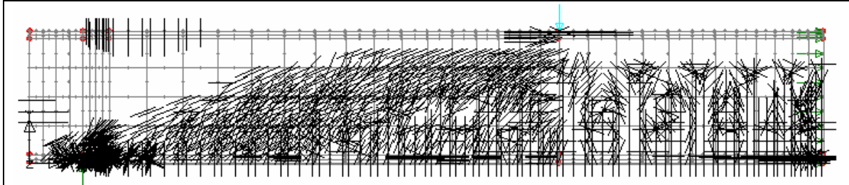
P=200 kN luk yükleme sonucu çatlak durumu
