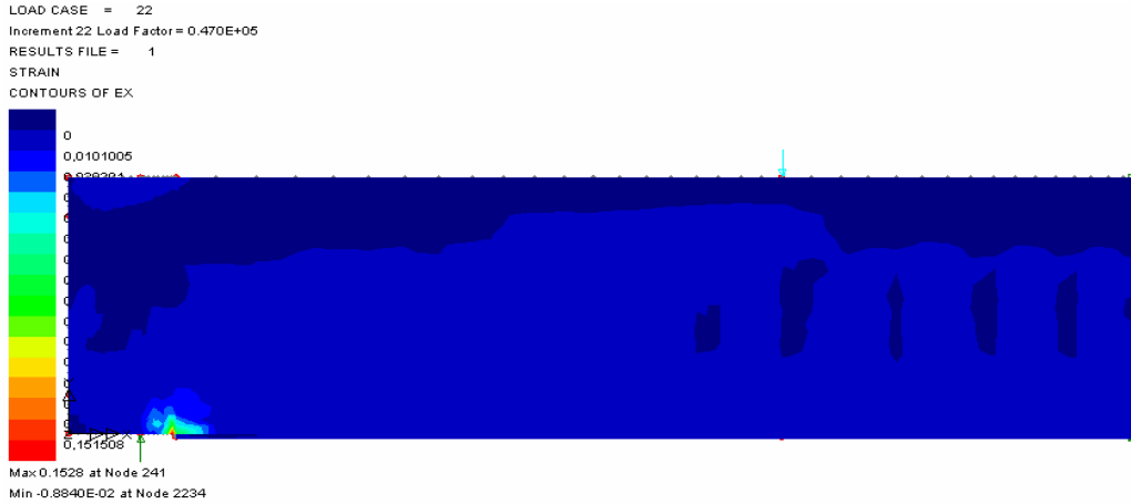
Şekil 5.21 A1 tipi sayısal kiriş modelinde meydana gelen birim zorlanma ( \epsilon_x ) değerleri değişimi
