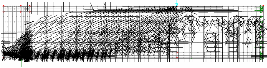
Şekil.5.58. B1 tipi sayısal kiriş modelinde P=200 KN luk yükleme sonucunda oluşan eğilme ve kesme çatlakları dağılımı
