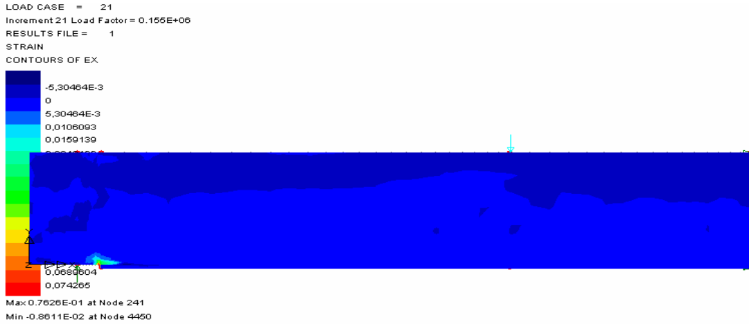
Şekil 5.74. B3 tipi sayısal kiriş modelinde meydana gelen birim zorlanma ( \epsilon_x ) değerleri değişimi
