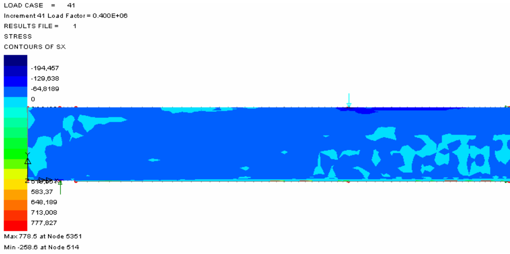
Şekil 5.140. D3 tipi sayısal kiriş modelinde doğrusal olmayan analiz sonucunda kiriş boyunca oluşan Normal Gerilme ( \sigma_x ) değişimi ve güçlendirme bölgesi detayı
