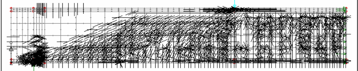
P=175 KN luk yükleme sonucu çatlak durumu
