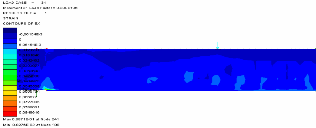
Şekil5.100. C2 tipi sayısal kiriş modelinde meydana gelen birim zorlanma( \epsilon_x ) değerleri değişimi
