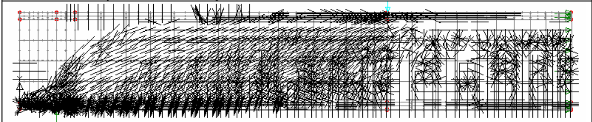
P=300 kN luk yükleme sonucu çatlak durumu
