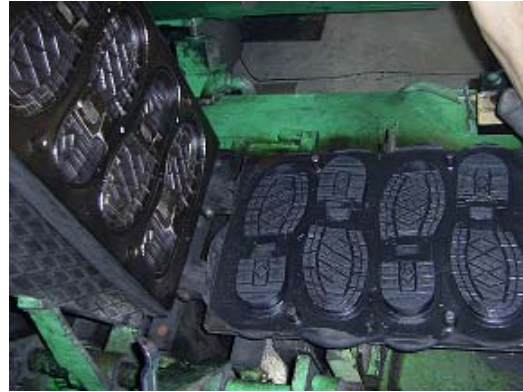
Şekil 3.3. Kauçuk hamurlarının vulkanizasyon presine yerleştirilmesi ve vulkanizasyon sonrası tabanların çıkarılması
