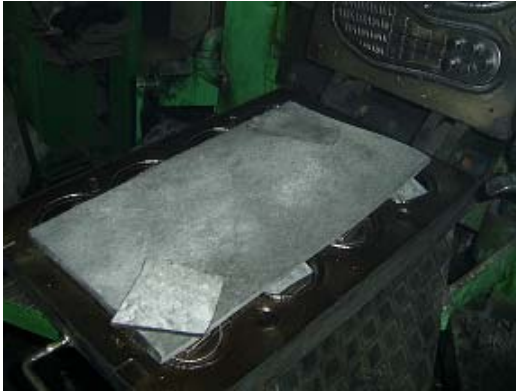
Şekil 3.3. Kauçuk hamurlarının vulkanizasyon presine yerleştirilmesi ve vulkanizasyon sonrası tabanların çıkarılması
