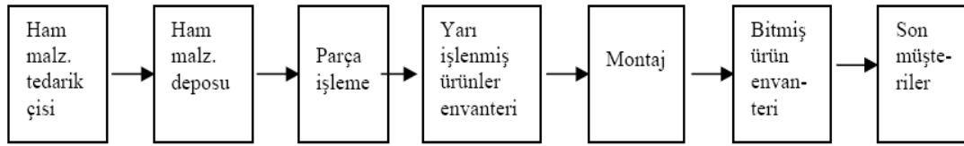
Şekil 3.1. Malzeme akışı açısından bir imalat sistemi (Tekez, 2006)
