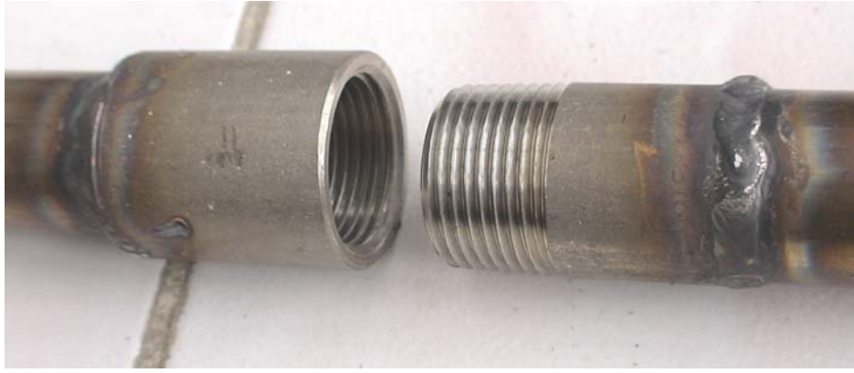
Resim 5.7. Boruların birbirine montajını sağlayan manşon-nipel bağlantısı.
