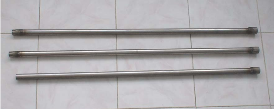
Resim 5.5. Her biri 1 m uzunluğundaki ürün toplama borularının oluşumunda kullanılan parçalar.
