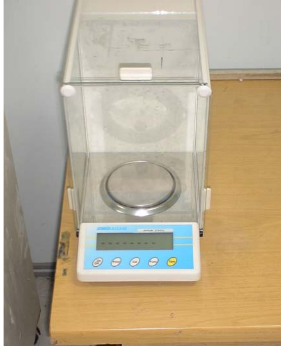
Resim 5.13. Numune alma kaplarının tartıldığı hassas terazi.
