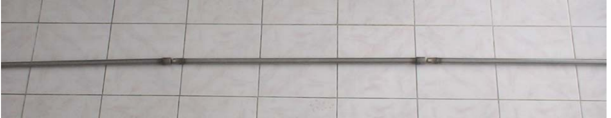
Resim 5.6. a) Ürün toplama borusunun montajlanmış gösterimi.
