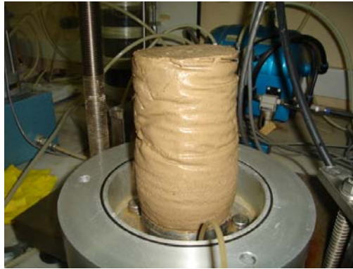
Foto Ek-1.14. %67 ince içeren ve %10 kil içeren numunenin DGO=0.25 deney sonu fotoğrafı
