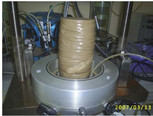
Foto Ek-1.15. %67 ince içeren ve %10 kil içeren numunenin DGO=0.20 deney sonu fotoğrafı
