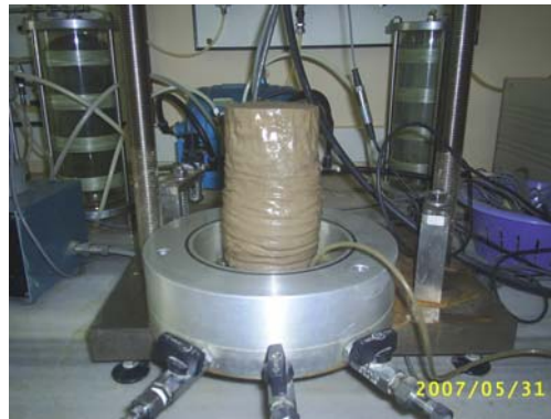
Foto Ek-1.12. %71 ince içeren ve %9 kil içeren numunenin DGO=0.15 deney sonu fotoğrafı
