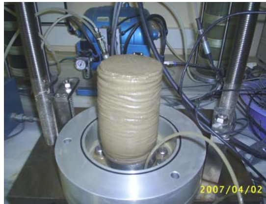
Foto Ek-1.1. %54 ince içeren ve %4 kil içeren zemin numunesi DGO=0.35 deney sonu fotoğrafı
