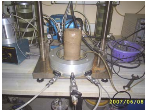
Foto Ek-1.28. %78 ince içeren ve %18 kil içeren numunenin DGO=0.15 deney sonu fotoğrafı
