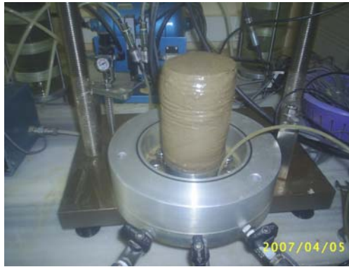
Foto Ek-1.4. %54 ince içeren ve %4 kil içeren zemin numunesi DGO=0.15 deney sonu fotoğrafı
