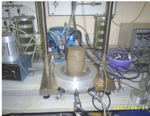
Foto Ek-1.2. %54 ince içeren ve %4 kil içeren zemin numunesi DGO=0.25 deney sonu fotoğrafı
