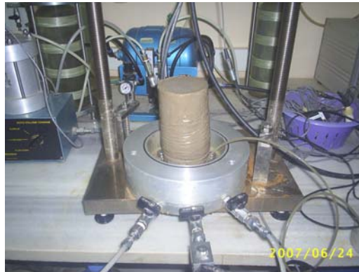
Foto Ek-1.22. %63 ince içeren ve %13 kil içeren numunenin DGO=0.20 deney sonu fotoğrafı
