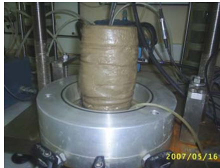
Foto Ek-1.7. %51 ince içeren ve %6 kil içeren zemin numunesi DGO=0.20 deney sonu fotoğrafı
