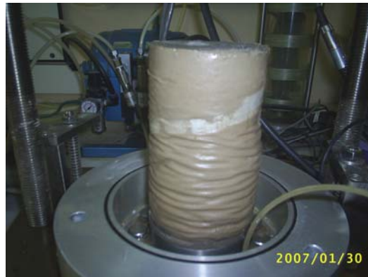
Foto Ek-1.21. %63 ince içeren ve %13 kil içeren numunenin DGO=0.25 deney sonu fotoğrafı
