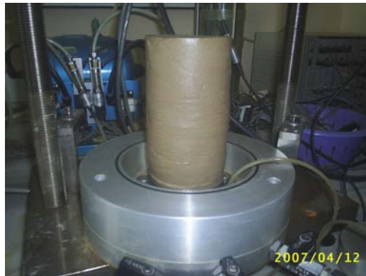
Foto Ek-1.19. %73 ince içeren ve %12 kil içeren numunenin DGO=0.20 deney sonu fotoğrafı
