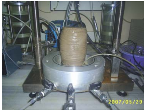
Foto Ek-1.11. %71 ince içeren ve %9 kil içeren numunenin DGO=0.20 deney sonu fotoğrafı
