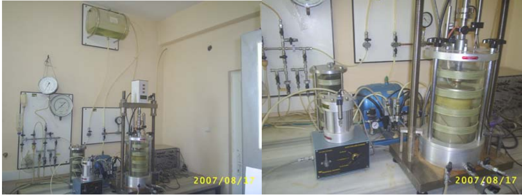
Foto 5.1. Dinamik üç eksenli deney sistemi ve cihazın parçaları
