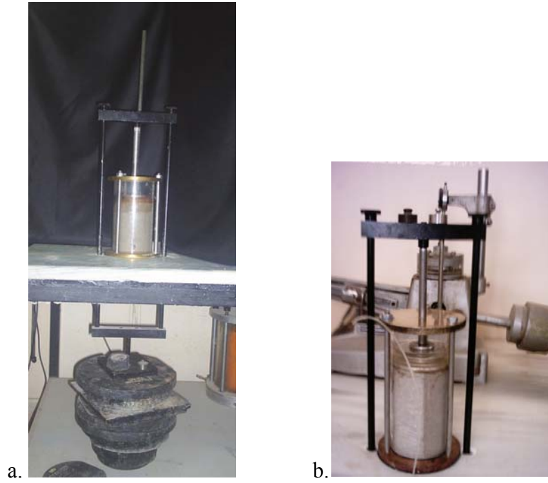
Foto 4.1. Konsolidasyon hücresinin yükleme sırasında görüntümü
