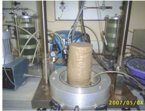
Foto Ek-1.10. %71 ince içeren ve %9 kil içeren numunenin DGO=0.25 deney sonu fotoğrafı
