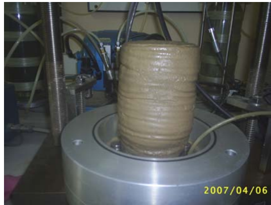
Foto Ek-1.8. %51 ince içeren ve %6 kil numunesinin DGO=0.15 deney sonu fotoğrafı
