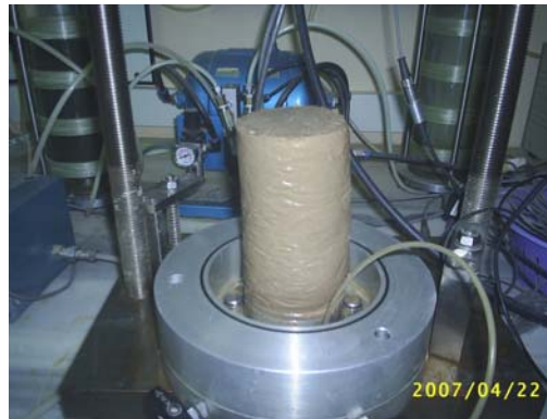
Foto Ek-1.17. %73 ince içeren ve %12 kil içeren numunenin DGO=0.35 deney sonu fotoğrafı
