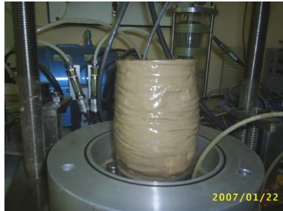
Foto Ek-1.26. %78 ince içeren ve %18 kil içeren numunenin DGO=0.25 deney sonu fotoğrafı
