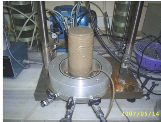
Foto Ek-1.18. %73 ince içeren ve %12 kil içeren numunenin DGO=0.25 deney sonu fotoğrafı
