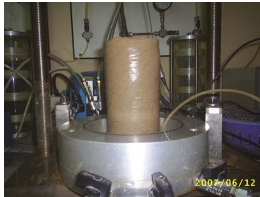
Foto Ek-1.23. %75 ince içeren ve %15 kil içeren numunenin DGO=0.25 deney sonu fotoğrafı
