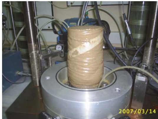
Foto Ek-1.16. %67 ince içeren ve %10 kil içeren numunenin DGO=0.15 deney sonu fotoğrafı
