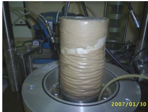
Foto Ek-1.20. %73 ince içeren ve %12 kil içeren numunenin DGO=0.15 deney sonu fotoğrafı
