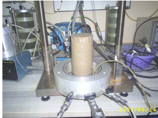
Foto Ek-1.24. %75 ince içeren ve %15 kil içeren numunenin DGO=0.20 deney sonu fotoğrafı
