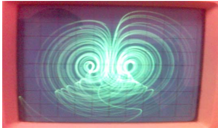
Şekil 5.11. Rikitake elektronik devresinin kaotik x - y , x - z , ve y - z kaotik çekicilerinin osiloskop çıkışları
