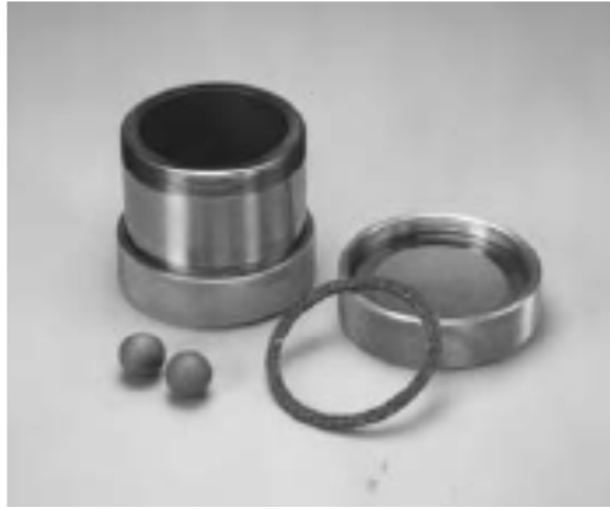
Şekil 4.4. Tungsten karbür havan, kapak, conta ve bilyeler [107].
