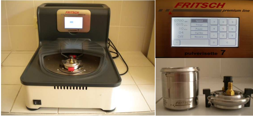
Şekil 5.4. Mekanik işlemlerin gerçekleştirildiği gezegensel değirmen ve paslanmaz çelik havanın resmi.
