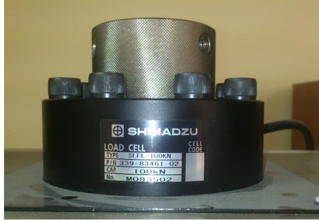
Şekil A.2. Çekme deney cihazı yük hücresi
