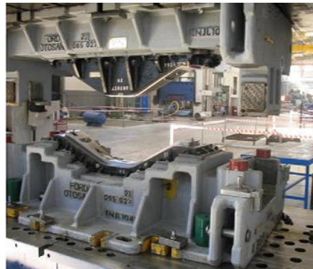
Şekil 4.1. Karmaşık yüzeyli bir sac metal malzeme ve formlama kalıpları [112]
