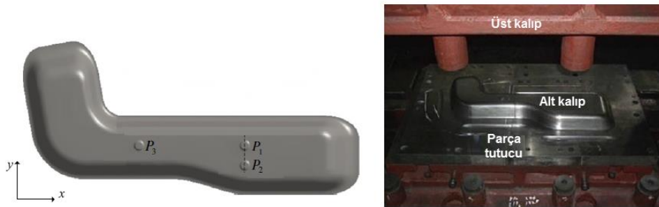
Şekil 4.12. Parça üzerindeki kontrol noktaları ve formlama kalıpları [125]
