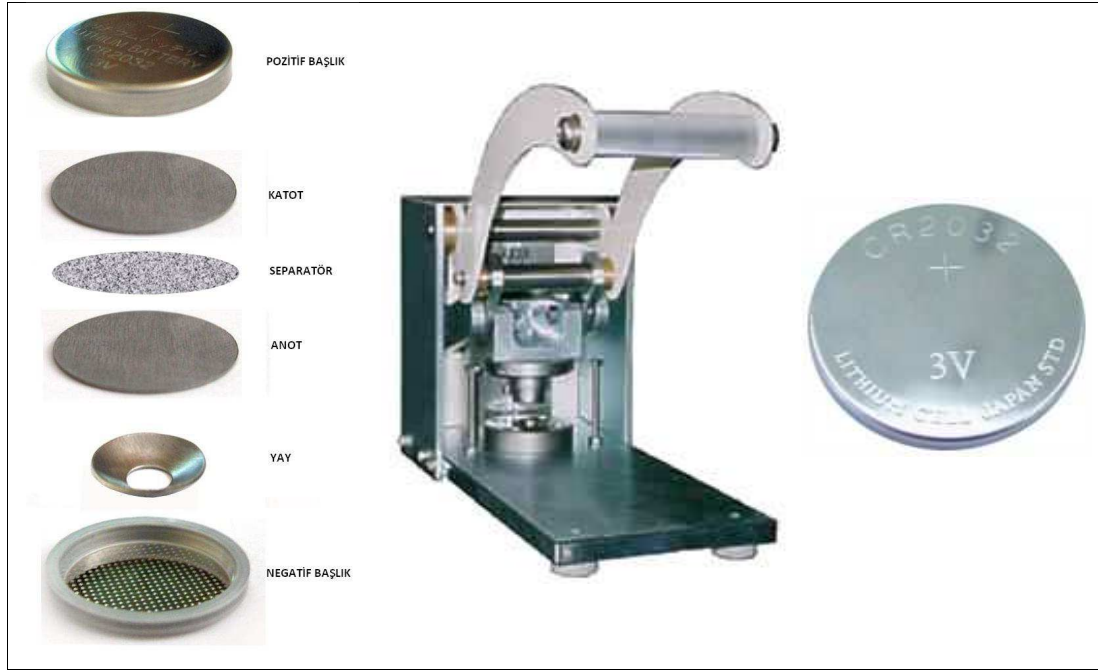
Şekil 5.2. Tipik bir CR2016 türü şarj edilebilir pil ve montajı.
