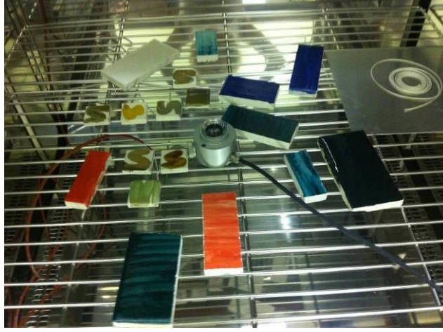
Şekil 5.73. İklimlendirme kabinindeki numuneler
